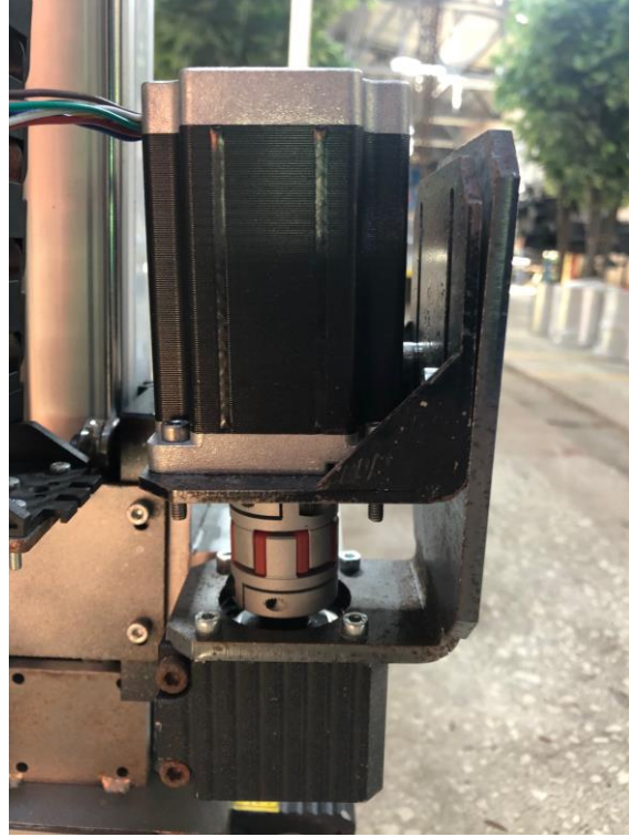
Şekil 3.. Test sisteminde kullanılan step motor
