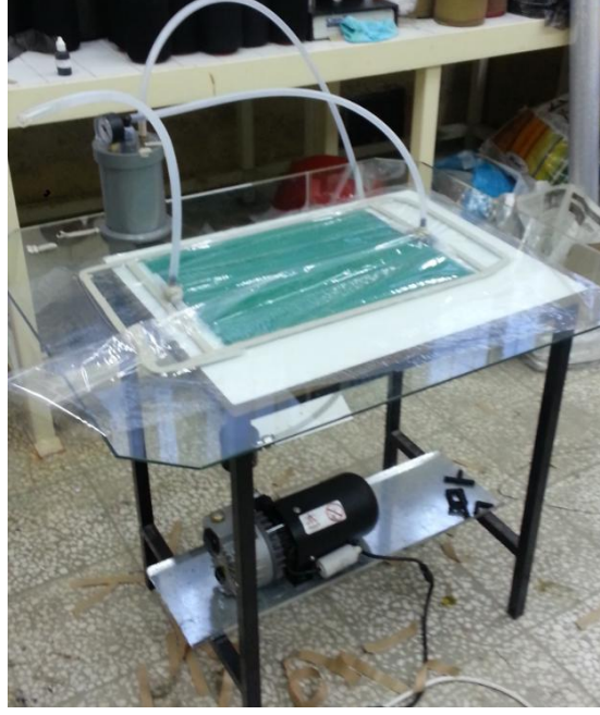
Şekil 3.3 Kompozit malzeme Üretimi
