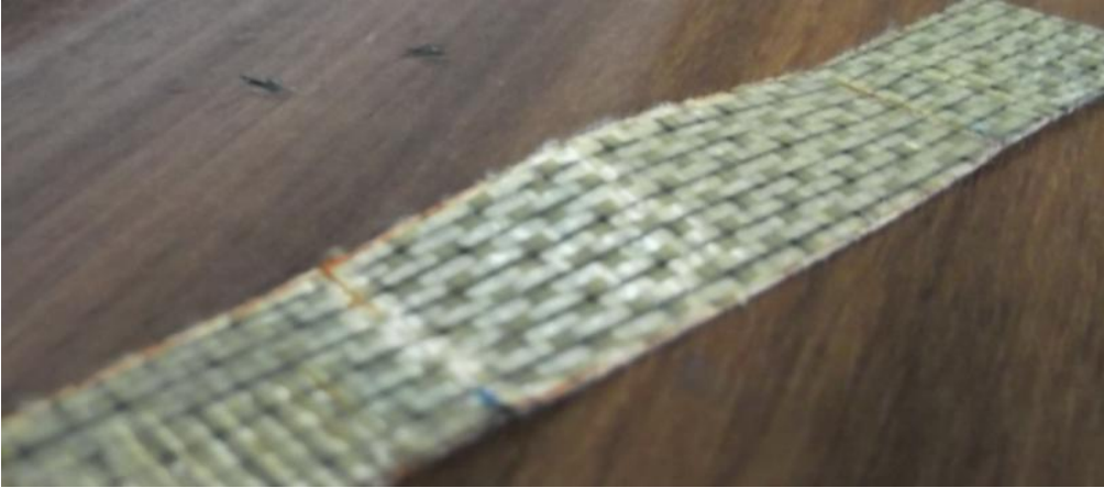
Şekil 3.16 İki Katmanlı Dokuma Aramid/Karbon Takviyeli Vinlester Kompozitte Termal Burkulma (Mod1)
