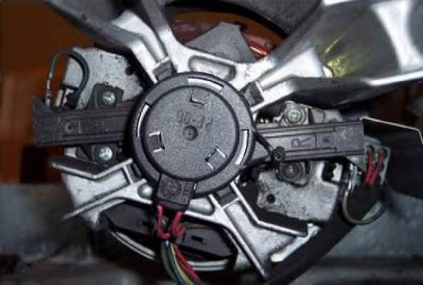
Şekil 1.14 Fırçaların motor üzerindeki montaj hali (Anonim 2015)
