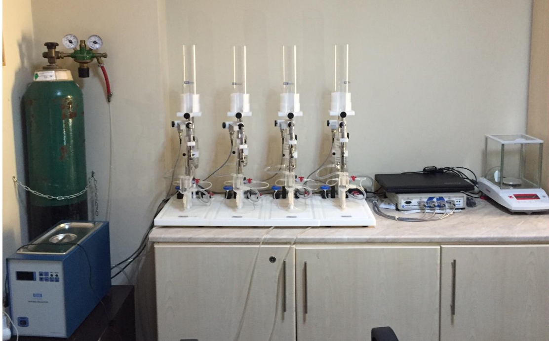
Resim 2. NKUTF Kalp Damar Cerrahisi ABD Vasküler laboratuvarında bulunan in vitro organ banyosu düzeneği
