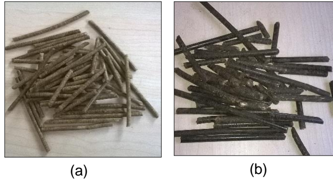
Şekil 4. Çeltik sapı pelet numuneleri: (a) %100 çeltik sapı, (b) %15 kömür tozu karışımı Figure 4. Paddy straw pellet samples: (a) 100% straw, (b) mixture with 15% coal powder)
