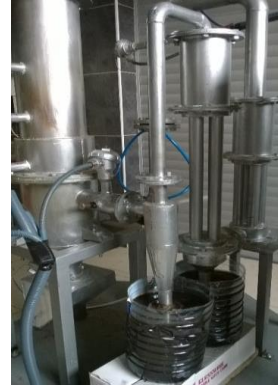
Şekil 2. Gaz temizleme sistemi
