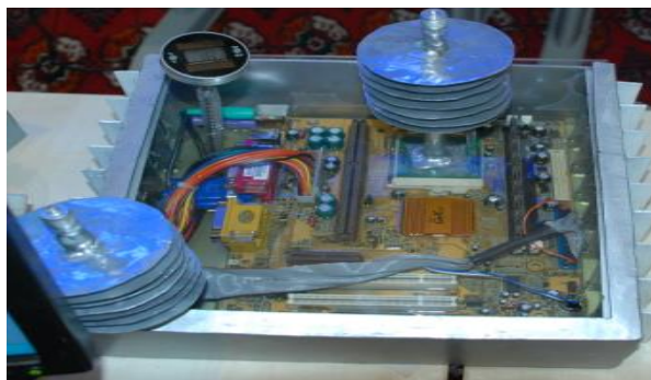
Рис. 2. Разработанная система охлаждения персонального компьютера на основе диэлектрической жидкости и тепловых труб
