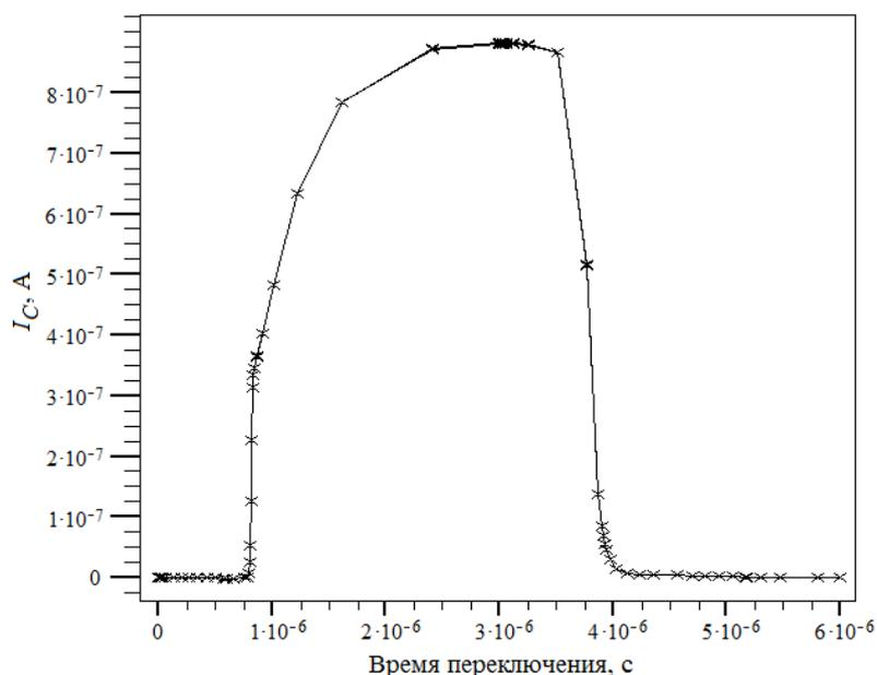
Рис. 5. Динамические характеристики исследуемой IGBT-структуры при вариации концентрации примеси в эмиттере биполярного транзистора  $N_E$ ,  $\text{см}^{-3}$  ( $1 \cdot 10^{18}$ ,  $1 \cdot 10^{19}$  и  $1 \cdot 10^{20}$ )
