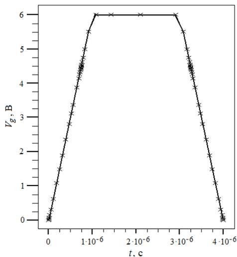
Рис. 3. Управляющий импульс, подаваемый на затвор исследуемой IGBT-структуры
