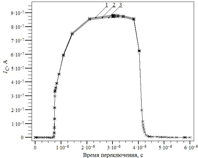
Рис. 4. Динамические характеристики исследуемой IGBT-структуре при вариации концентрации примеси в базе биполярного транзистора  $N_B$ ,  $\text{см}^{-3}$  ( $N_B = 6,71 \cdot 10^{13}$  (1);  $6,61 \cdot 10^{13}$  (2);  $6,51 \cdot 10^{13}$  (3))
