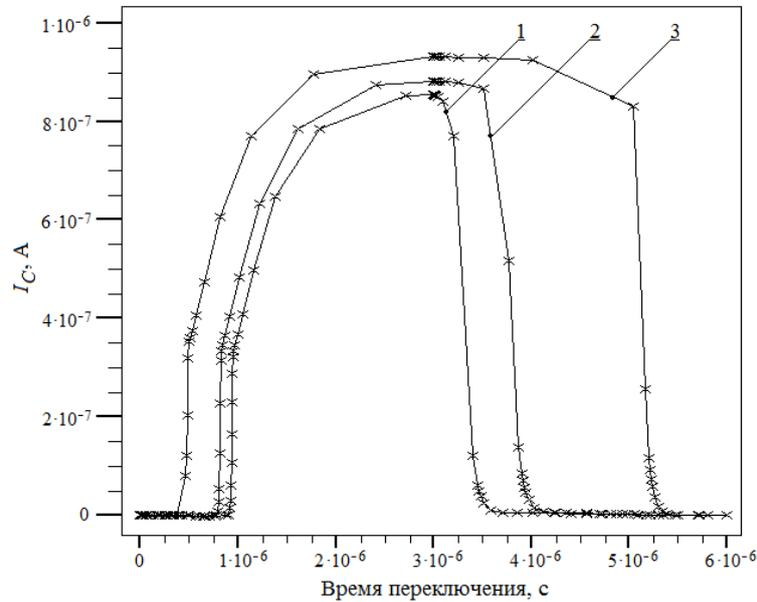
Рис. 6. Динамические характеристики исследуемой IGBT-структуры при вариации дозы имплантированной примеси  $D_{CH}$  в области канала МОП-транзистора, см<sup>-2</sup> ( $7,4 \cdot 10^{12}$  (1);  $6,4 \cdot 10^{12}$  (2);  $3,4 \cdot 10^{12}$  (3))
