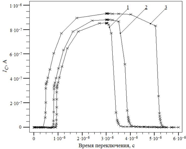
Рис. 6. Динамические характеристики исследуемой IGBT-структуры при вариации дозы имплантированной примеси  $D_{CH}$  в область канала МОП-транзистора,  $\text{см}^{-2}$  ( $7,4 \cdot 10^{13}$  (1);  $6,4 \cdot 10^{12}$  (2);  $3,4 \cdot 10^{12}$  (3))
