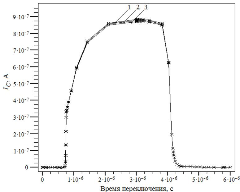
Рис. 4. Динамические характеристики исследуемой IGBT-структуры при вариации концентрации примеси в базе биполярного транзистора  $N_B$ ,  $\text{см}^{-3}$  ( $N_B = 6,71 \cdot 10^{13}$  (1);  $6,61 \cdot 10^{13}$  (2);  $6,51 \cdot 10^{13}$  (3))
