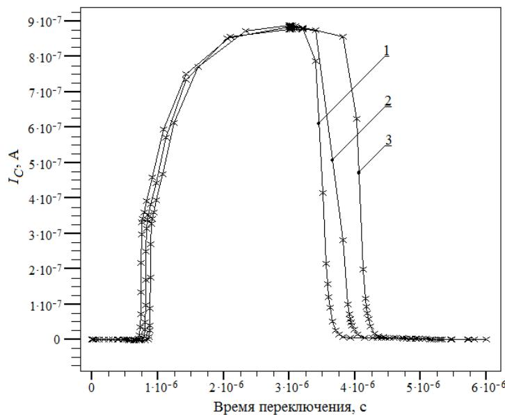
Рис. 7. Динамические характеристики исследуемой IGBT-структуры при вариации энергии имплантации примеси  $E_{CH}$  в область канала МОП-транзистора, кэВ (110 (1); 120 (2); 130 (3))
