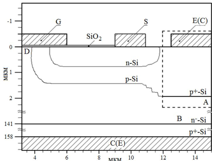
Рис. 2. Геометрия исследованной IGBT-структуры:
