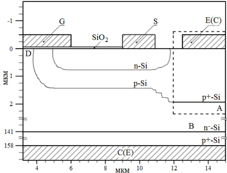
Рис. 2. Геометрия исследованной IGBT-структурь:
