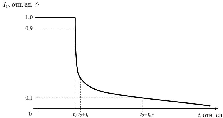
Рис. 1. Типичная зависимость тока коллектора  $I_c$  от времени при выключении IGBT [5]
