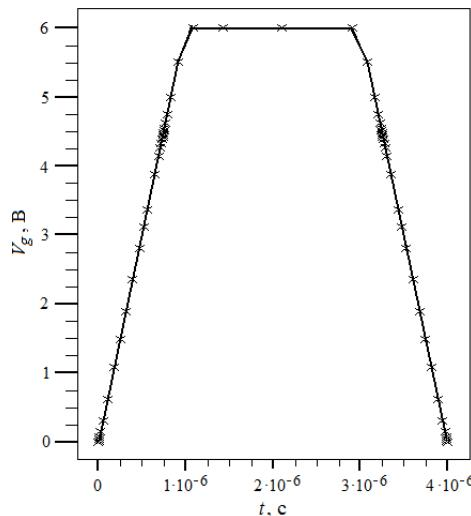
Рис. 3. Управляющий импульс, подаваемый на затвор исследуемой IGBT-структурь
