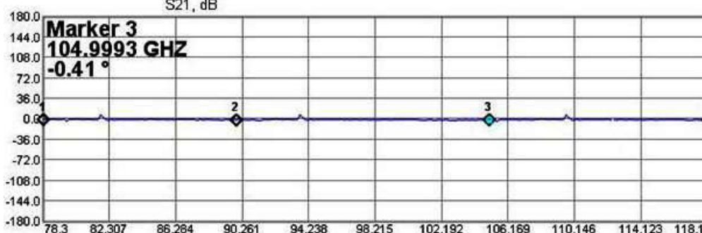
Рис. 6. Коэффициент передачи S_{21} исследуемого СВЧ устройства с применением цифровой фильтрации сигналов по алгоритму устранения пиков
