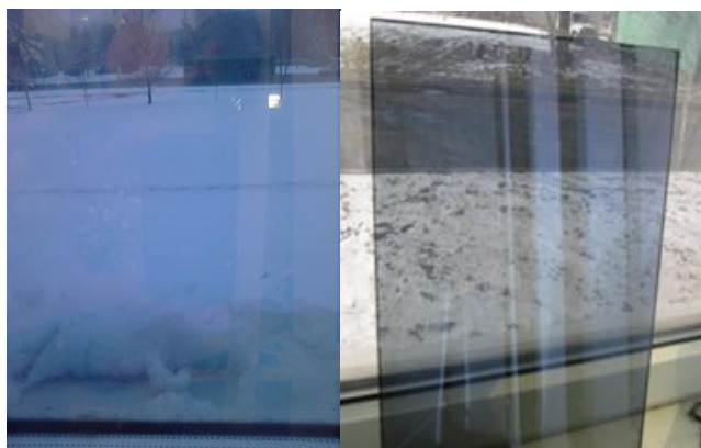
Рис. 5. Внешний вид прозрачных электромагнитных экранов (слева – ZrO 2 -Ni-Cu-Ni-ZrO 2 , справа – Ni-ZrO 2 )
