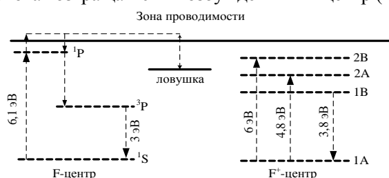
Рис. 3. Схематическое изображение процессов поглощения и испускания F - и F^+ -центров в оксиде алюминия
