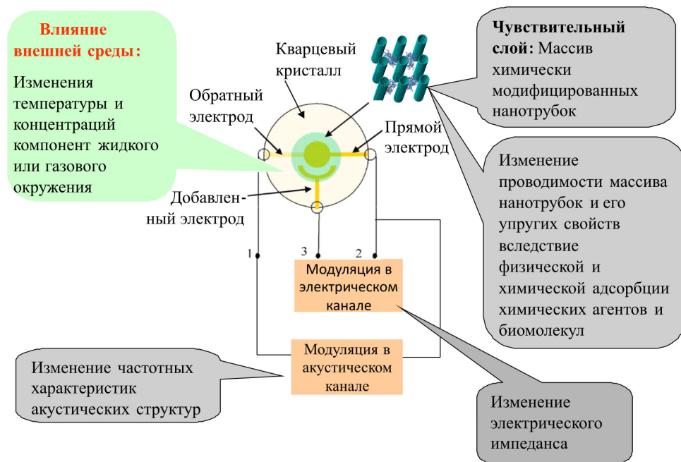
Рис. 1. Схема работы перспективных акустоэлектронных и импедансных сенсорных структур с чувствительным слоем на основе массивов углеродных нанотрубок
