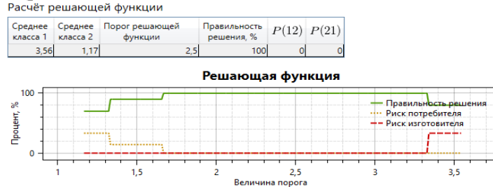
Рис. 4. Таблица «Расчет решающей функции» и графики зависимости правильности решения, риска потребителя и риска изготовителя от величины порога решающей функции
