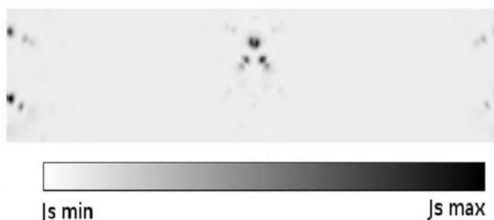
Рис. 2. Распределение магнитной плотности в дефектной структуре ZnO
