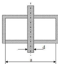
Рис. 2. Поперечное сечение волновода с диэлектрическим стержнем
