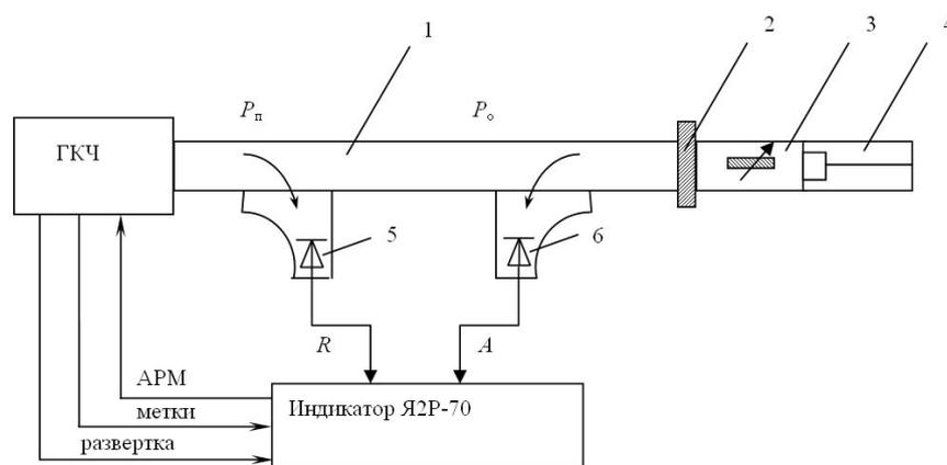
Рис. 1. Структурная схема измерительной установки
