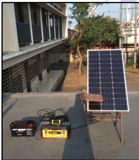
Gambar 4. Pengujian efisiensi Solar Cell dengan PLTS Portable sebelum di hybrid
