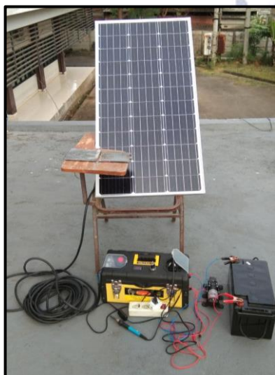
Gambar 5. Pengujian efisiensi Solar Cell dan Thermoelectric Generator (TEG) saat sudah di hybrid serta pengukuran beban DC dan AC
