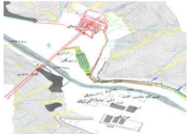
شکل ۲- شمای پروژه احداث تونل انتقال آب غرب کشور و واحد-های موجود در آن
