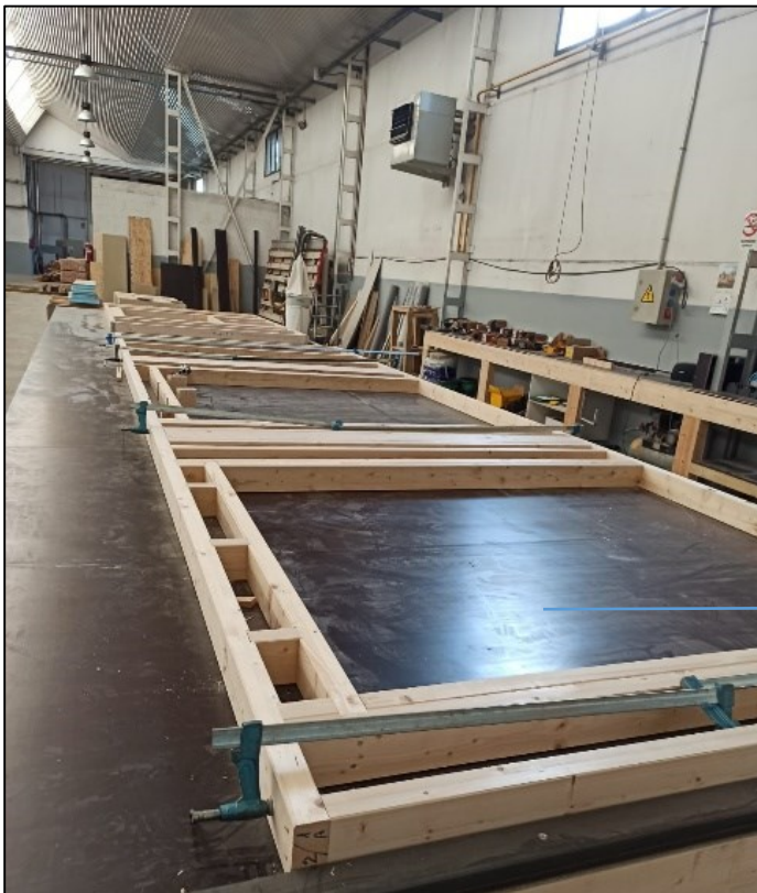
Fotografía 1. Parte del bastidor de forjado de la casa prefabricada en madera.
