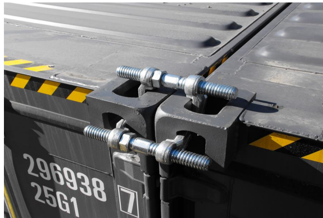
Figura II.36. Bridge Fitting en módulos marítimos
