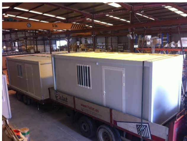
Figura I.1. Transporte de módulos totalmente armados (BALAT, 2015)
