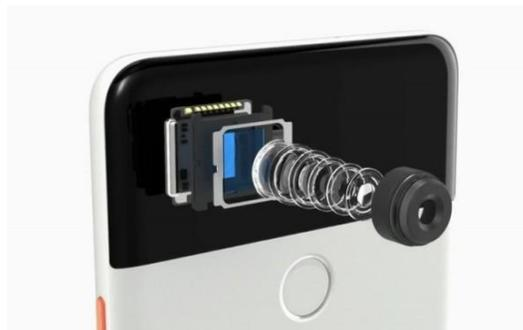
**Gambar 2. Struktur Kamera Smartphone**
