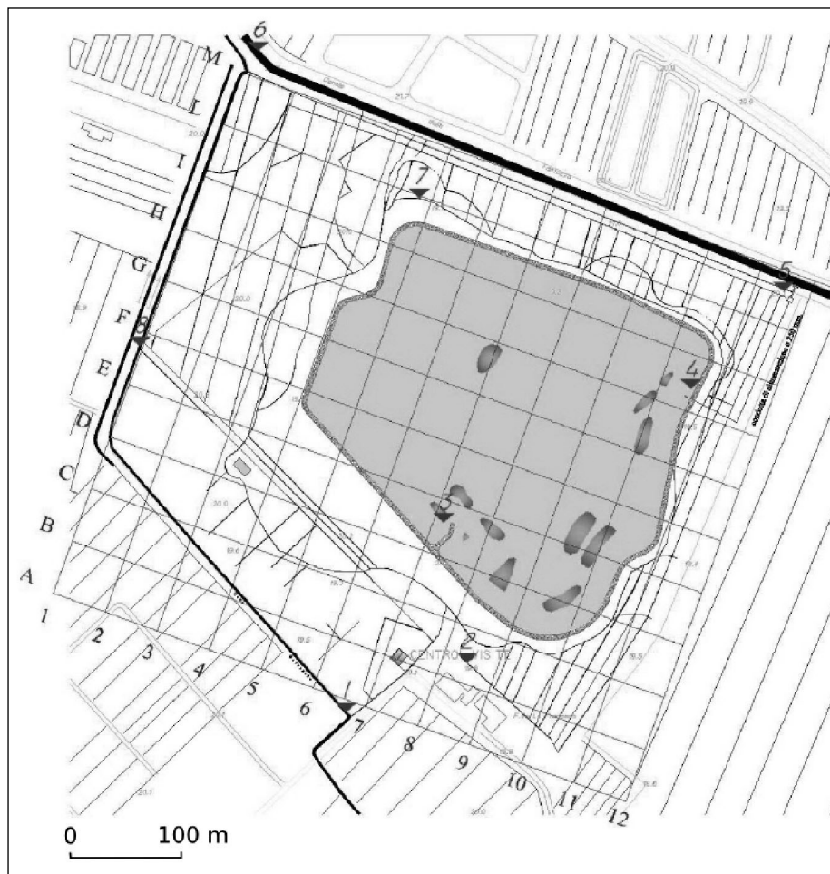
Fig. 5 – Cartografia di dettaglio dell'area allagata e delle parti emerse (lato del reticolo 50 m). I punti di prelievo dell'acqua per le analisi di laboratorio sono indicati dai triangoli Fig. 5 – Detailed map of the dry ground and wet area (in grey). Triangles show location of water samples (from pond and canals) taken for laboratory analyses
