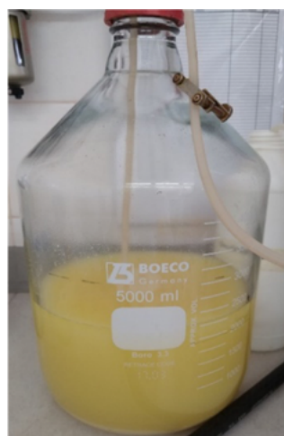
Figura 2. Permeado de suero líquido esterilizado. El permeado contiene una elevada concentración de sales, el proceso de esterilización favorece su precipitación, el sedimento debe ser separado antes de utilizar el permeado de suero en la fermentación.
