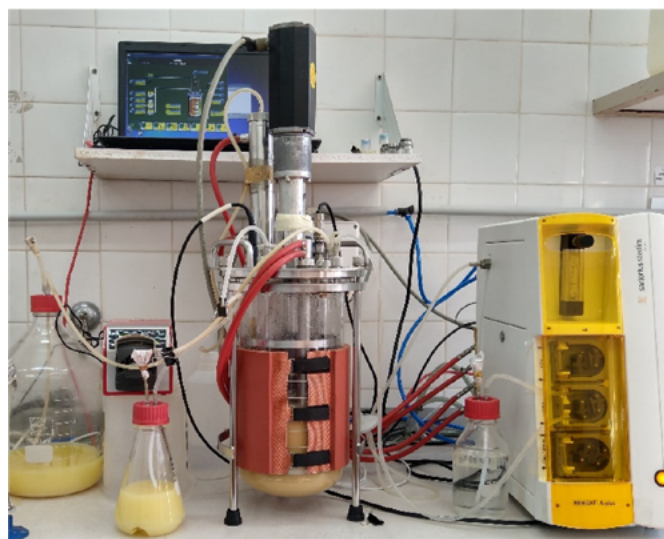
Figura 3. Cultivo Fed-Batch de E. coli 6576 en biorreactores de 5 L (Biostat A plus, Sartorius).
