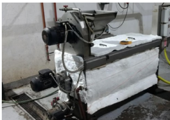
Termoamasadora industrial adaptada para tratamientos térmicos de alperujo
