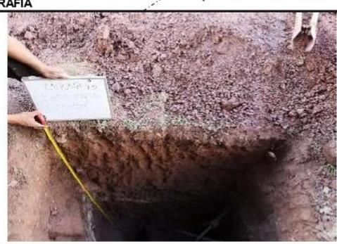
**OBSERVACIONES:** Del registro de excavación que se muestra se ha extraído las muestras MAB y MIB para los ensayos correspondientes, los mismos que han sido extraídas, colectadas, transportadas y preparadas de acuerdo a las normas vigentes en nuestro país y homologadas con normas A.S.T.M, (registro sin escala)
