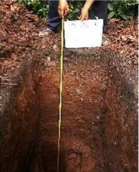
**OBSERVACIONES:** Del registro de excavación que se muestra se ha extraído las muestras MAB y MIB para los ensayos correspondientes, los mismos que han sido extraídas, colectadas, transportadas y preparadas de acuerdo a las normas vigentes en nuestro país y homologadas con normas A.S.T.M. (registro sin escala)
