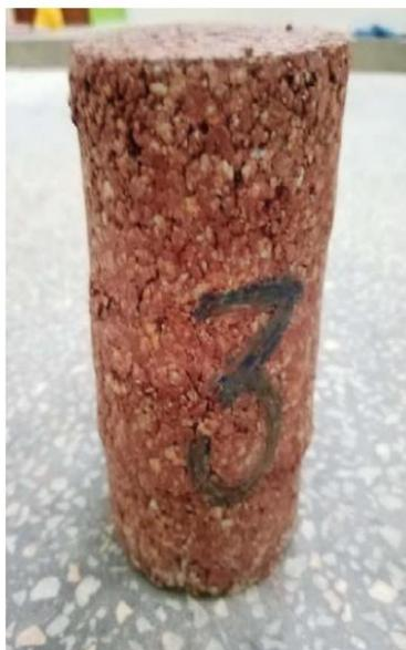
**FOTOGRAFÍA.** - N° 01,02 y 03 de los especímenes fallados en el ensayo triaxial UU.
