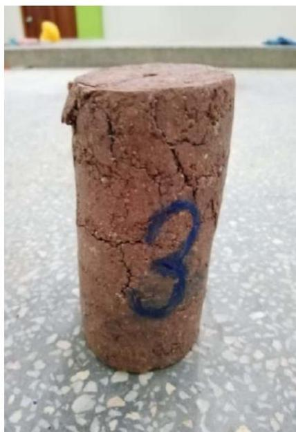
**FOTOGRAFÍA.** - N° 01,02 y 03 de los especímenes fallados en el ensayo triaxial UU.
