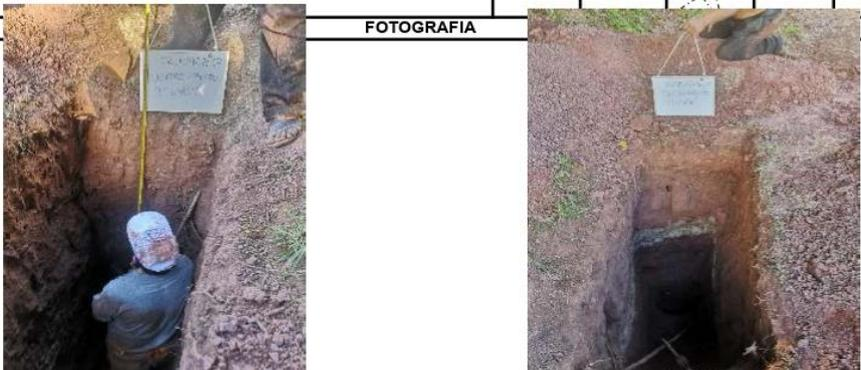
**OBSERVACIONES:** Del registro de excavación que se muestra se ha extraído las muestras MAB y MIB para los ensayos correspondientes, los mismos que han sido extraídas, colectadas, transportadas y preparadas de acuerdo a las normas vigentes en nuestro país y homologadas con normas A.S.T.M, (registro sin escala)
