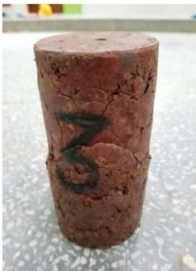
**FOTOGRAFÍA.** - N° 01,02 y 03 de los especímenes fallados en el ensayo triaxial UU.
