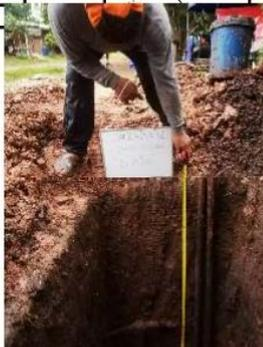
**OBSERVACIONES:** Del registro de excavación que se muestra se ha extraído las muestras MAB y MIB para los ensayos correspondientes, los mismos que han sido extraídas, colectadas, transportadas y preparadas de acuerdo a las normas vigentes en nuestro país y homologadas con normas A.S.T.M, (registro sin escala)
