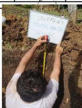
**OBSERVACIONES:** Del registro de excavación que se muestra se ha extraído las muestras MAB y MIB para los ensayos correspondientes, los mismos que han sido extraídas, colectadas, transportadas y preparadas de acuerdo a las normas vigentes en nuestro país y homologadas con normas A.S.T.M, (registro sin escala)
