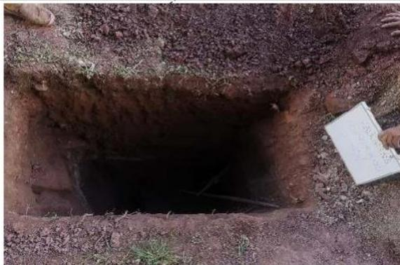
**OBSERVACIONES:** Del registro de excavación que se muestra se ha extraído las muestras MAB y MIB para los ensayos correspondientes, los mismos que han sido extraídas, colectadas, transportadas y preparadas de acuerdo a las normas vigentes en nuestro país y homologadas con normas A.S.T.M. (registro sin escala)
