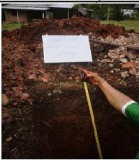
**OBSERVACIONES:** Del registro de excavación que se muestra se ha extraído las muestras MAB y MIB para los ensayos correspondientes, los mismos que han sido extraídas, colectadas, transportadas y preparadas de acuerdo a las normas vigentes en nuestro país y homologadas con normas A.S.T.M, (registro sin escala)
