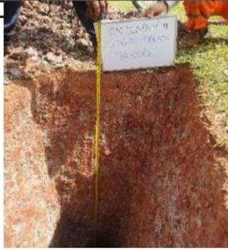
**OBSERVACIONES:** Del registro de excavación que se muestra se ha extraído las muestras MAB y MIB para los ensayos correspondientes, los mismos que han sido extraídas, colectadas, transportadas y preparadas de acuerdo a las normas vigentes en nuestro país y homologadas con normas A.S.T.M. (registro sin escala)
