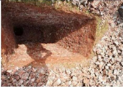
**OBSERVACIONES:** Del registro de excavación que se muestra se ha extraído las muestras MAB y MIB para los ensayos correspondientes, los mismos que han sido extraídas, colectadas, transportadas y preparadas de acuerdo a las normas vigentes en nuestro país y homologadas con normas A.S.T.M. (registro sin escala)
