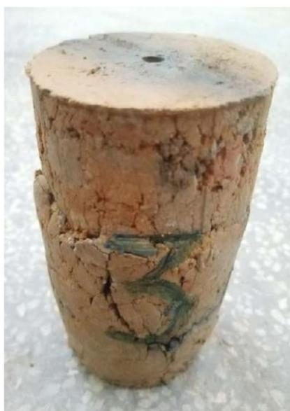
**FOTOGRAFÍA.** - N° 01,02 y 03 de los especímenes fallados en el ensayo triaxial UU.
