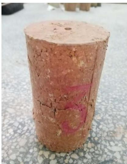
**FOTOGRAFÍA.** - N° 01,02 y 03 de los especímenes fallados en el ensayo triaxial UU.
