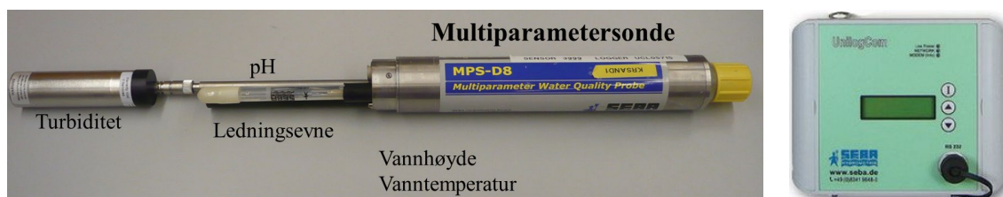
Figur 2.1 Multiparametersonde (MPS-D8) for kontinuerlige automatiske målinger i miljøbøyer Farrisvannet og UnilogCom (datalogger og modem) benyttet i miljøbøyer.
