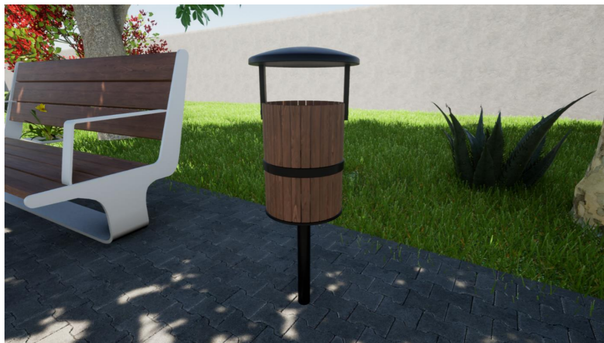
Imagen 418: Propuesta de basurero tipo 1: Metal y madera con tablonces de 2" y se encuentra anclado al piso. Fuente: Villalobos, J., Torres, L. & Castillo, A. (2021)
