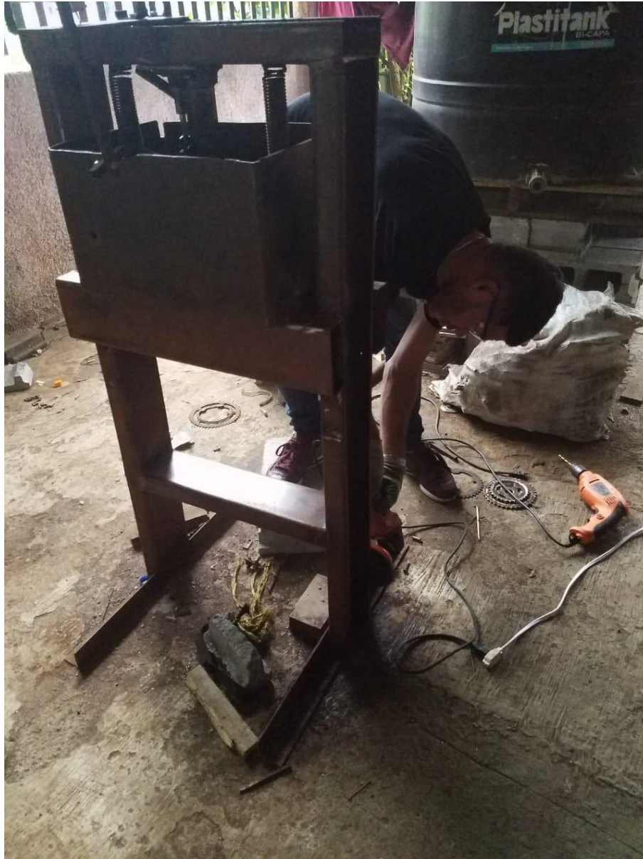
Eliminando escorias y puliendo la estructura.
