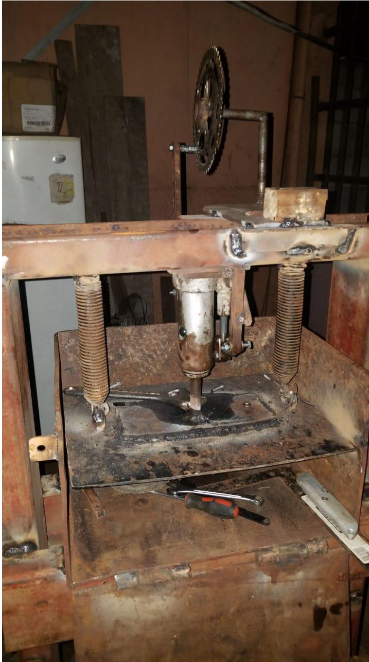
Gata hidráulica, Resortes, Deposito para las botellas y la estrella colocados.
