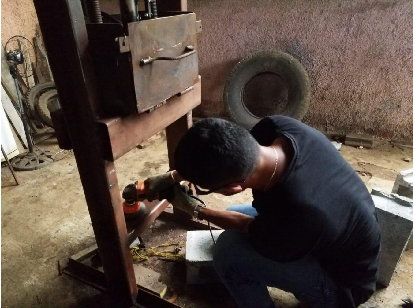
Eliminando escorias y puliendo la estructura.
