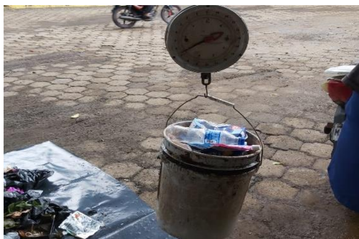
Fotografía No.2. pesaje para obtención de densidades de RS
