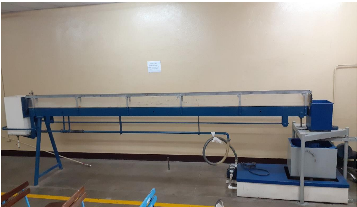
Figura 12: Estado del canal hidráulico antes de la restauración y mantenimiento
