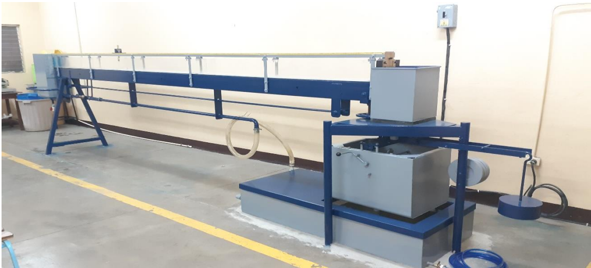
Figura 53: Canal hidráulica con su debido montaje.
