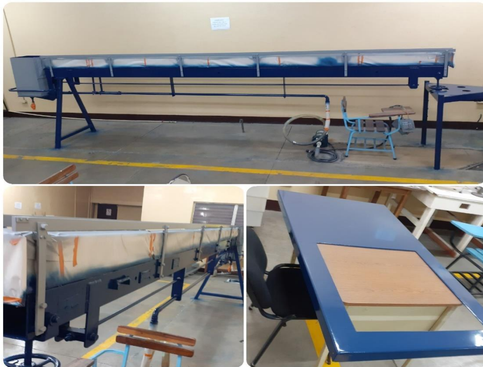
Figura 51: Aplicación de pintura final, color azul.
