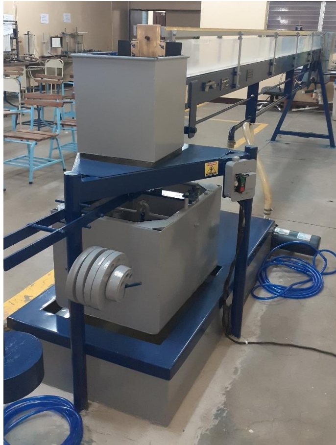
Figura 54: Canal hidráulico con su debido montaje.
