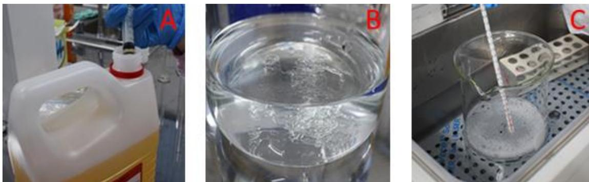
**Figura 6. 11.** Preparación y clarificación de TWEEN 80 al 0.1%. **A:** Toma de muestra de Tween 80, **B:** Dilución de TWEEN 80 con agua destilada y **C:** Clarificación de TWEEN 80 al 0.1% en Baño María a 68°C durante 3 horas (Fuente propia).
