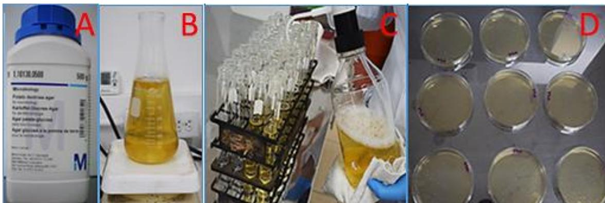
**Figura 6.2.** Preparación de medios de cultivo. **A:** medio de cultivo PDA en su envase, **B:** calentamiento a 500°C y con agitación a 31.42 rad/s del medio de cultivo en el Hot Plate, **C:** Dispensación del medio de cultivo en tubos de ensayo para su posterior esterilización en el autoclave y **D:** Medio de cultivo solidificado en placas Petri (Fuente propia).
