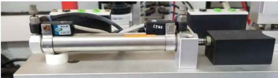
*Figura 8 Cilindro electro neumático*
