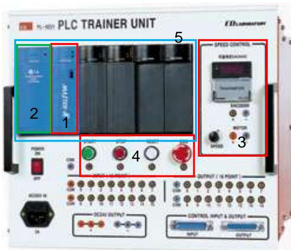
Figura 4 panel de control del PLC. (Ficha técnica serie ED-4031)
