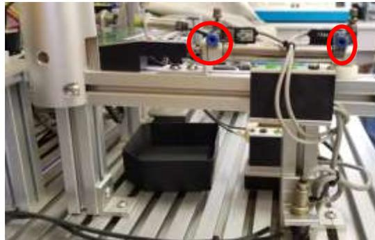
*Figura 30 Puntos de conexión de la manguera con aire comprimido en los cilindros electro neumáticos*
