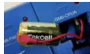
Figura 43 Inspección del estado de la batería
