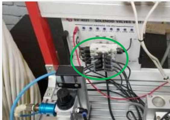
*Figura 9 Unidad de Válvulas Solenoides del sistema electro neumático*
