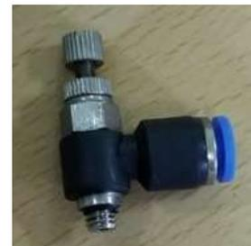
*Figura 31 Válvula de conexión de un solo toque, con regulador de flujo*
