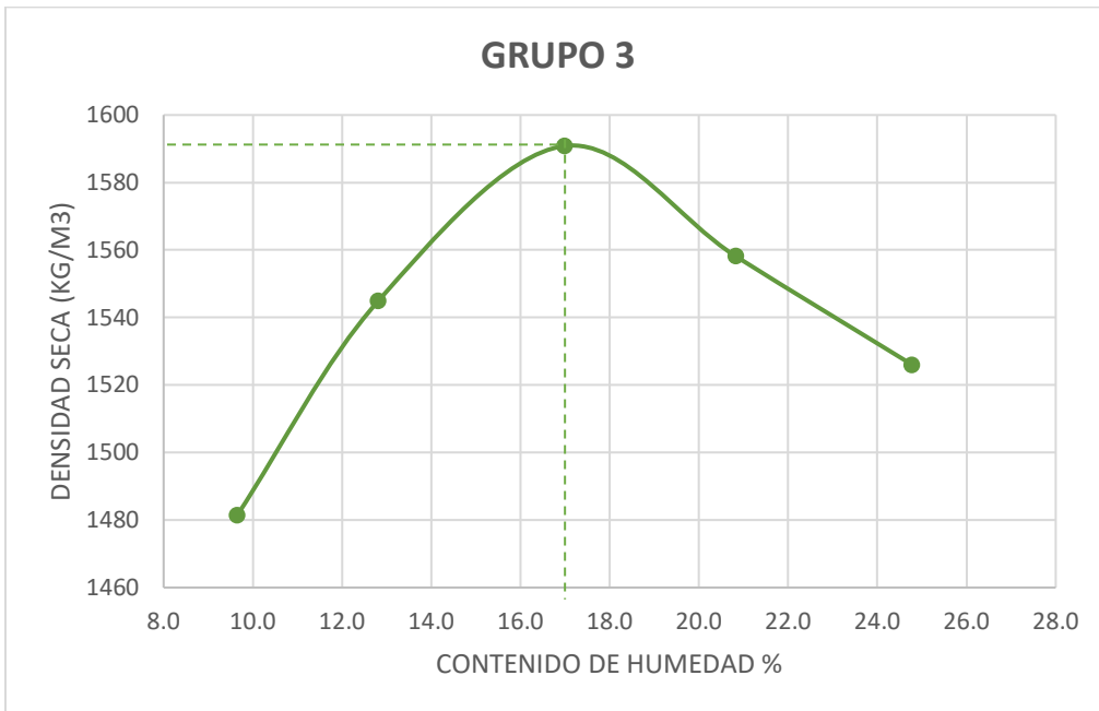
Gráfico No. 5 Densidad seca máxima vs humedad óptima
