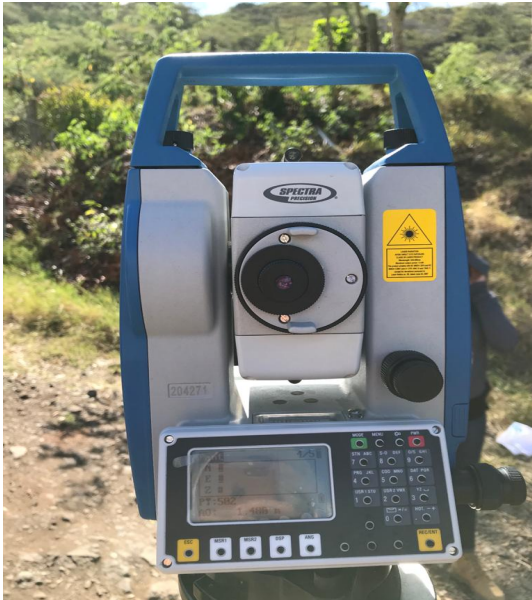
Fotografía No.9 Estación total utilizada para el levantamiento topográfico
