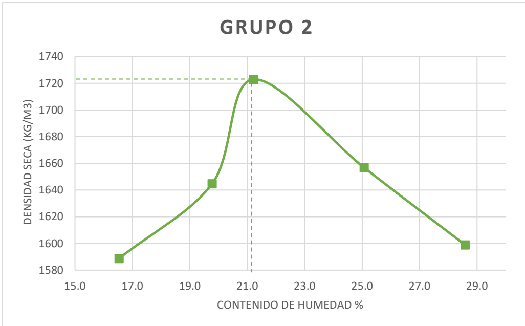
Gráfico No. 4 Densidad seca máxima vs humedad óptima
