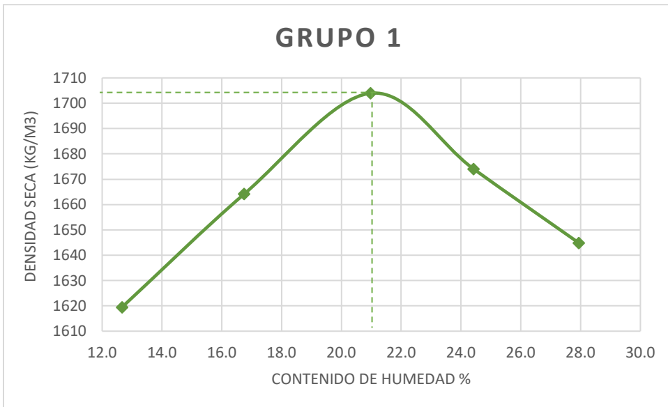
Gráfico No. 3 Densidad seca máxima vs humedad óptima
