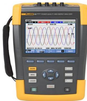
Ilustración 2. Analizador de redes eléctrica FLUKE 435
