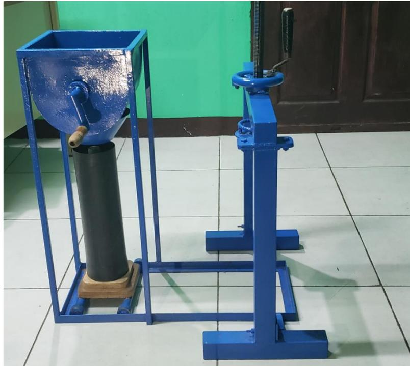
Anexo 23: Introducción de aserrín en el molde para briqueta.
