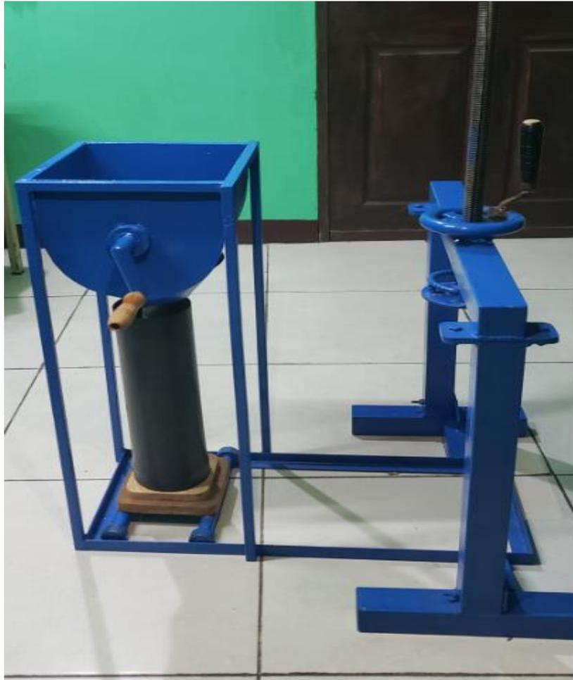
Anexo 5: Maquina compactadora ensamblada.
