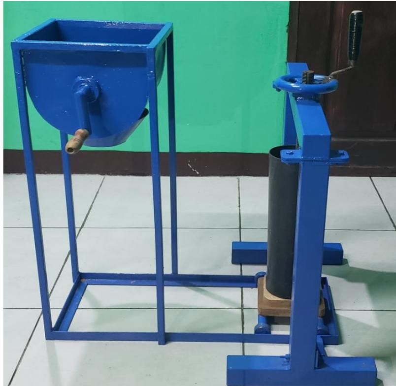
Anexo 25: Compactación del material para fabricación de briqueta.
