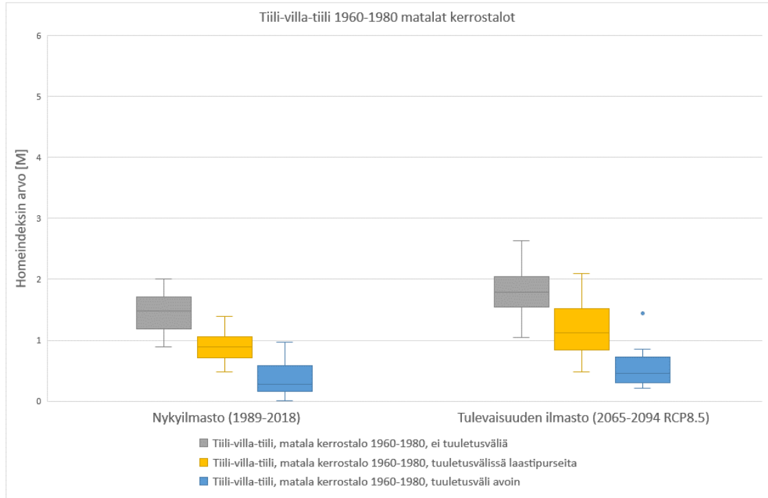
Kuva 16. Tiili-villa-tiili-rakenteisten matalien kerrostalojen vertailu etelän julkisivulle Vantaan ilmastossa. Tarkastelupiste lämmöneristeen ulkopinta homehtumisherkkyyssluokassa HHL3.
