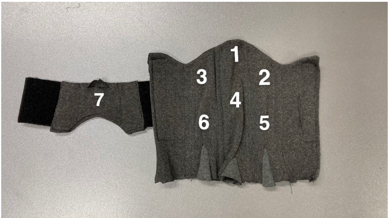
Kuva 1. Kaulurimallinen tekstiilipohjainen mittauslaite. Mittauslaitteen etuosassa on kolme kujaa, joista jokaisessa on kaksi sensoria. Mittauslaitteen takaosassa on tasku yhdelle sensorille. Kuvaan merkityt numerot 1-7 osoittavat sensoreiden paikat kaulurissa.
