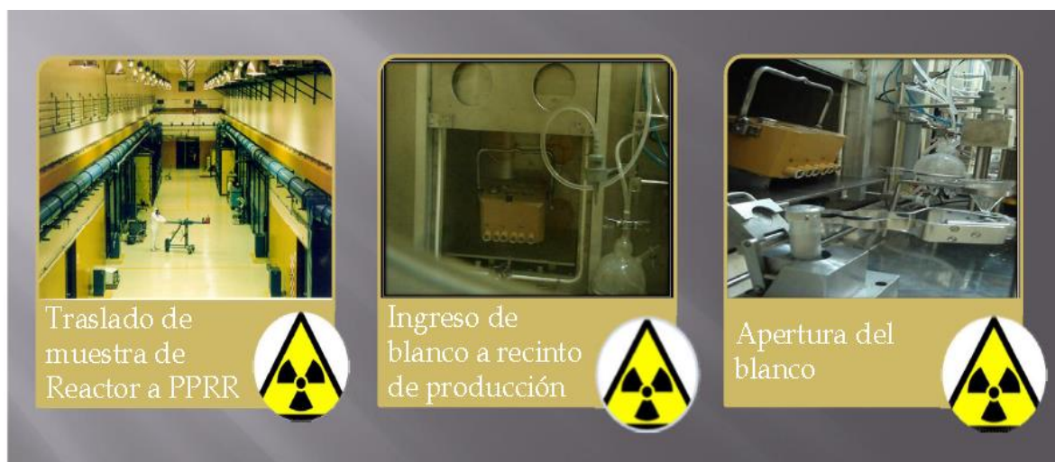
Figura. N°18: Traslado de muestras irradiadas e ingreso a los recintos de producción.
