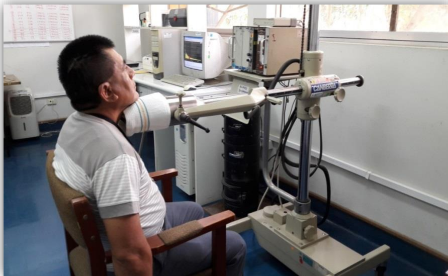
Figura. N°36: Medición “In Vivo”, de incorporación de ^{131}\text{I} en tiroides (Fuente: Laboratorio de Dosimetría Interna - 2017 - IPEN)
