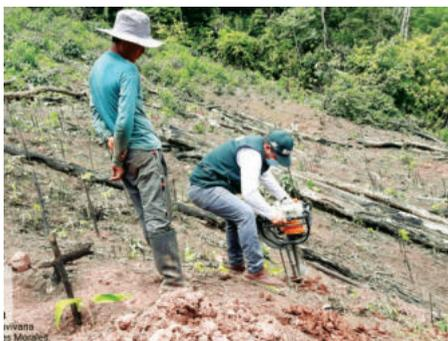
Figura 15: Hoyado mecanizado (maquina poseadora).
