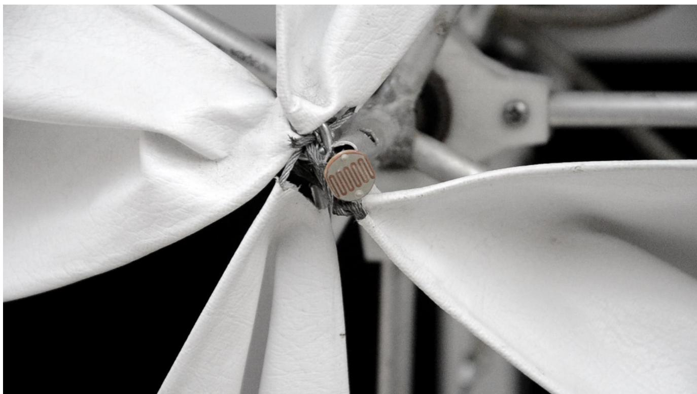
(Figura 18.21). Detalle del sensor LDR en el centro delantero de la fachada dinámica.
