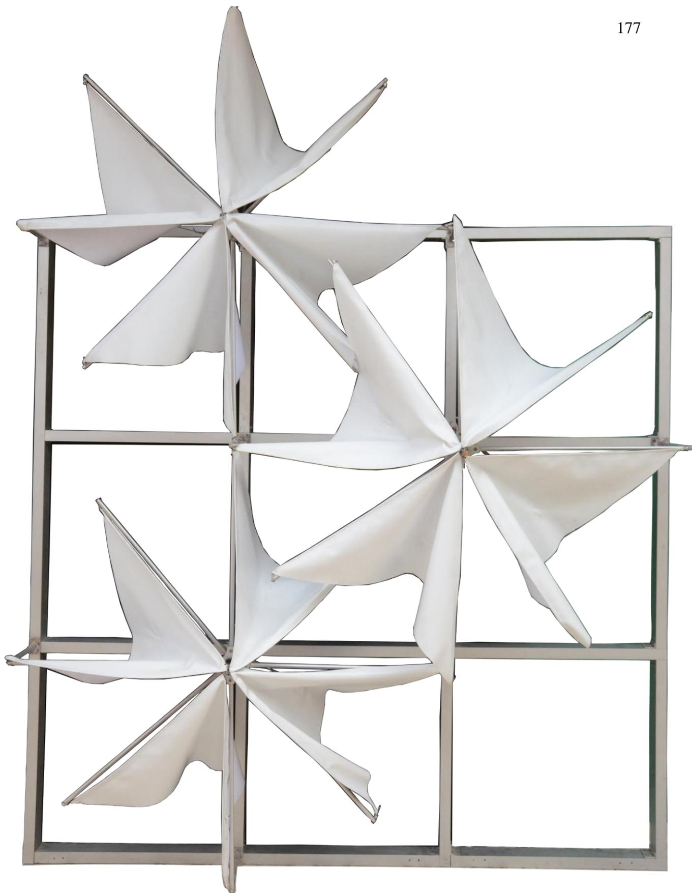
(Figura 18.17). Elevación del modelo escala 1/2 de la fachada dinámica abierta.
