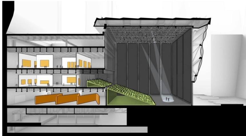
(Figura 9.21) Corte interior. La fachada móvil se “abre” y permite que la anterior área de exposiciones al aire libre se transforme en un anfiteatro interior. Recuperado de: <https://theshed.org/about/building>
