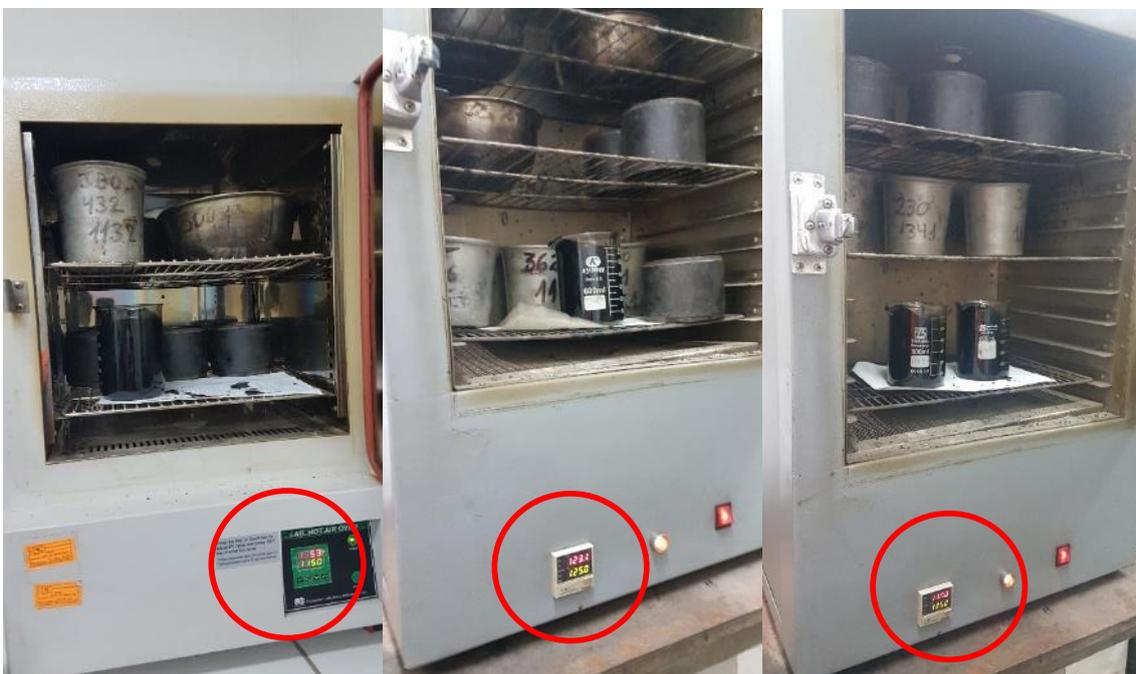
Después de haber llegado a la temperatura deseada, en la Figura 50, se procede con la adición del ligante asfáltico con el tensoactivo incluido con la finalidad que sean mezclados y compactados a la temperatura deseada, en las figura51, se muestran las temperaturas con que fueron mezcladas.
