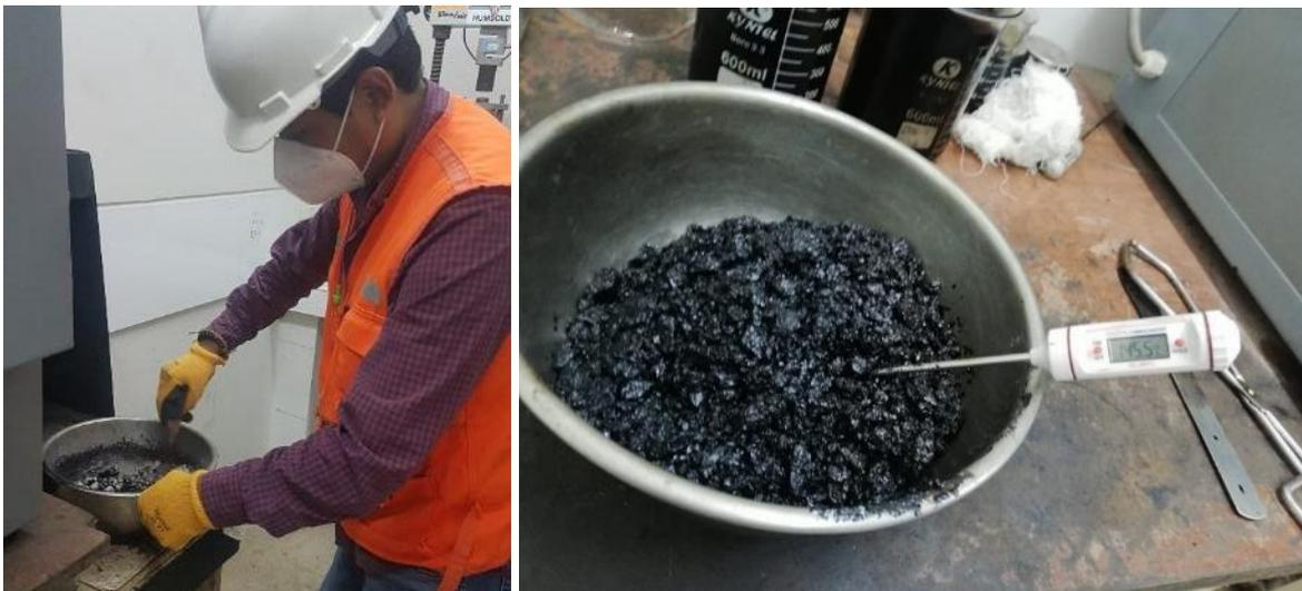
Luego del mezclado de los agregados con el ligante asfáltico, en la Figura 40, se coloca un papel no absorbente del tamaño del diámetro del molde y se procede a verter el contenido en el molde y se chusea fuertemente la mezcla 15 veces alrededor del perímetro y 10 veces en
