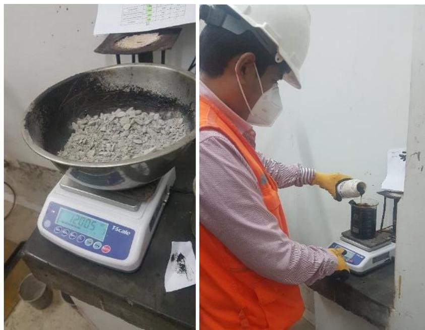
Luego, se distribuye el ligante asfáltico con el aditivo tensoactivo en vasos precipitados y son ingresados conjuntamente con lo áridos en los hornos a las temperaturas de 115, 125 y 135 °C, ver Figura 49.
