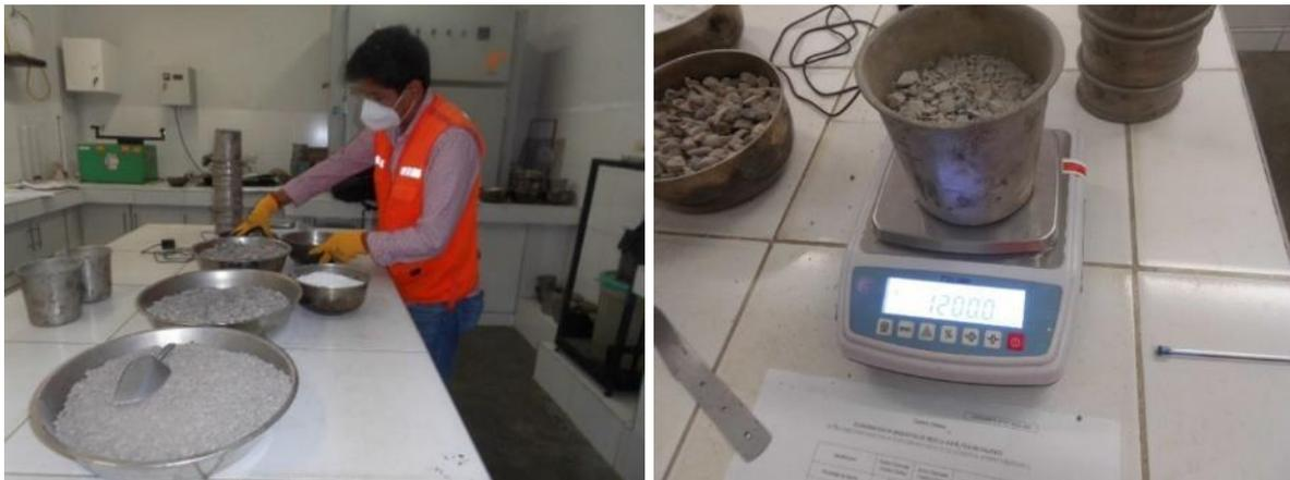
Una vez pesado, se ingresa al horno a temperatura de fabricación de la mezcla asfáltica, luego en la Figura 38, se adiciona el aditivo de mejorador de adherencia a 0.50 % en el ligante asfáltico y luego, se vierte el contenido óptimo de asfalto 6.70 % conjuntamente con el mejorador de adherencia en la gradación de la mezcla. El pesaje del contenido óptimo de asfalto fue de  $1200 \text{ gr} \times 6.70 \% = 80.4 \text{ gr}$ .
