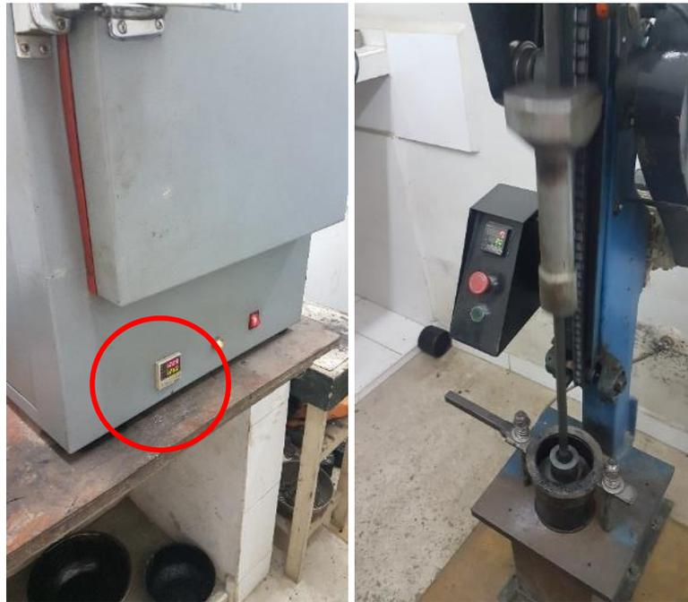
De acuerdo a la metodología del ensayo, se procedió en la Figura 63, con la obtención del número de golpes a un porcentaje de vacíos entre 6 a 8% siguiendo la metodología Marshall para la preparación de briquetas. Para ello, se prepararon los especímenes y se compactaron en ambas caras a diferentes números de golpes y se determinó los porcentajes de vacíos.
