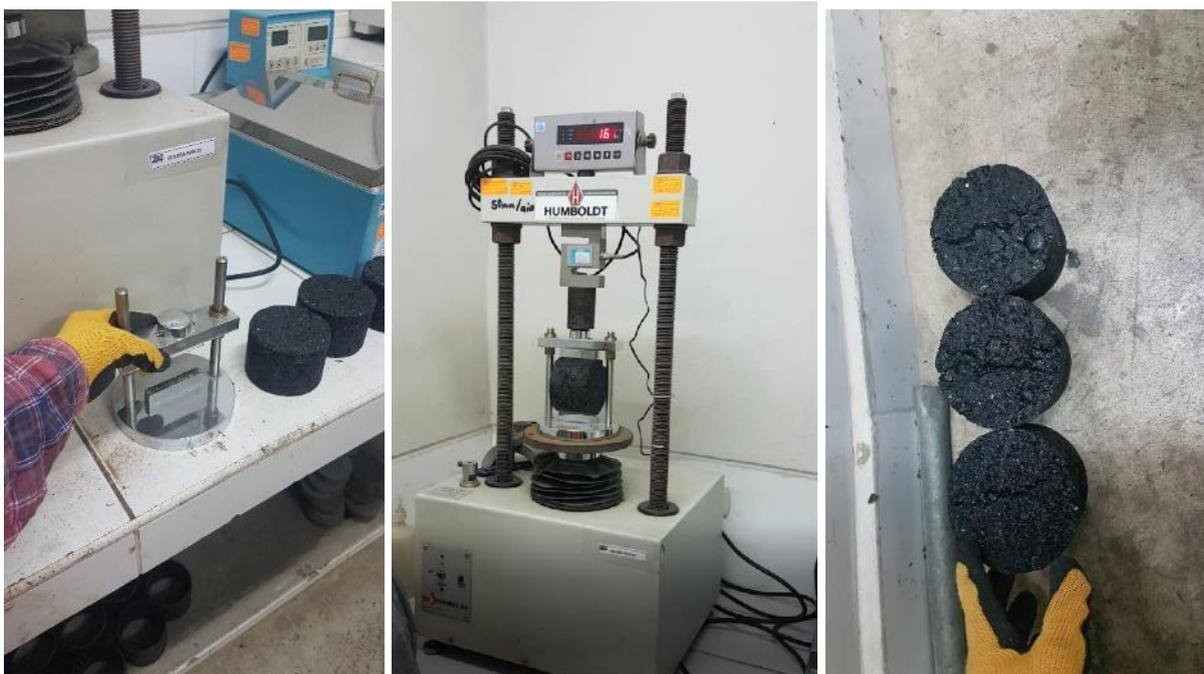
Luego, las 03 briquetas restantes son preparadas para ser sometidas al primer ciclo de congelamiento a una temperatura de  $-18\text{ }^{\circ}\text{C}$  por 16 horas. Ver Figura 67.
