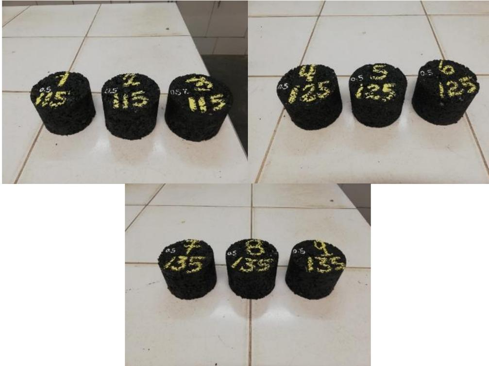
Luego, los especímenes una vez compactadas se dejan enfriar a temperatura ambiente y se procede con la toma de datos de cada briqueta, peso al aire, peso en el agua y peso del secado en agua. Después, en la Figura 55, las briquetas son colocadas en baño maría a 60 °C por media hora y luego son colocadas en la máquina de carga para observar y tomar datos de su resistencia a la carga monotónica.
