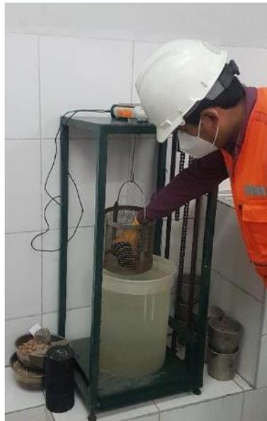
Luego, en la Figura 43, se procede en llevar las briquetas a baño maría a una temperatura de 60 °C, por 30 minutos, procediendo después en la colocación de cada briqueta en la máquina de carga y con un dial para la lectura del flujo Marshall, la carga máxima medida fue la estabilidad Marshall.
