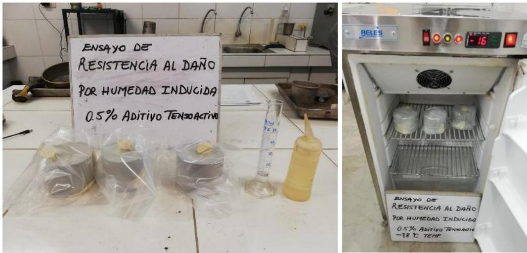
En la Figura 68, las briquetas pasaron al siguiente ciclo de deshielo en baño maría a  $60\text{ }^{\circ}\text{C}$  por 24 horas, luego los especímenes son aperturadas de sus envolturas para su posterior pesaje.
