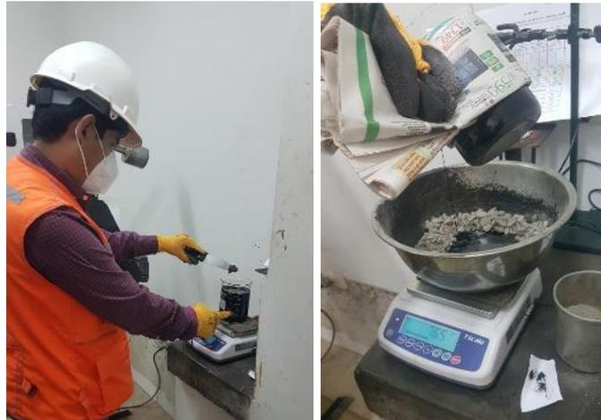
Luego en la Figura 39, se procede con el mezclado de la mezcla asfáltica en caliente, hasta obtener todos los agregados recubiertos por el ligante asfáltico. A continuación, se muestra la temperatura de mezclado que se encuentra en el rango de 141-145 °C, de acuerdo a la carta de viscosidad vs temperatura del PEN 120/150.
