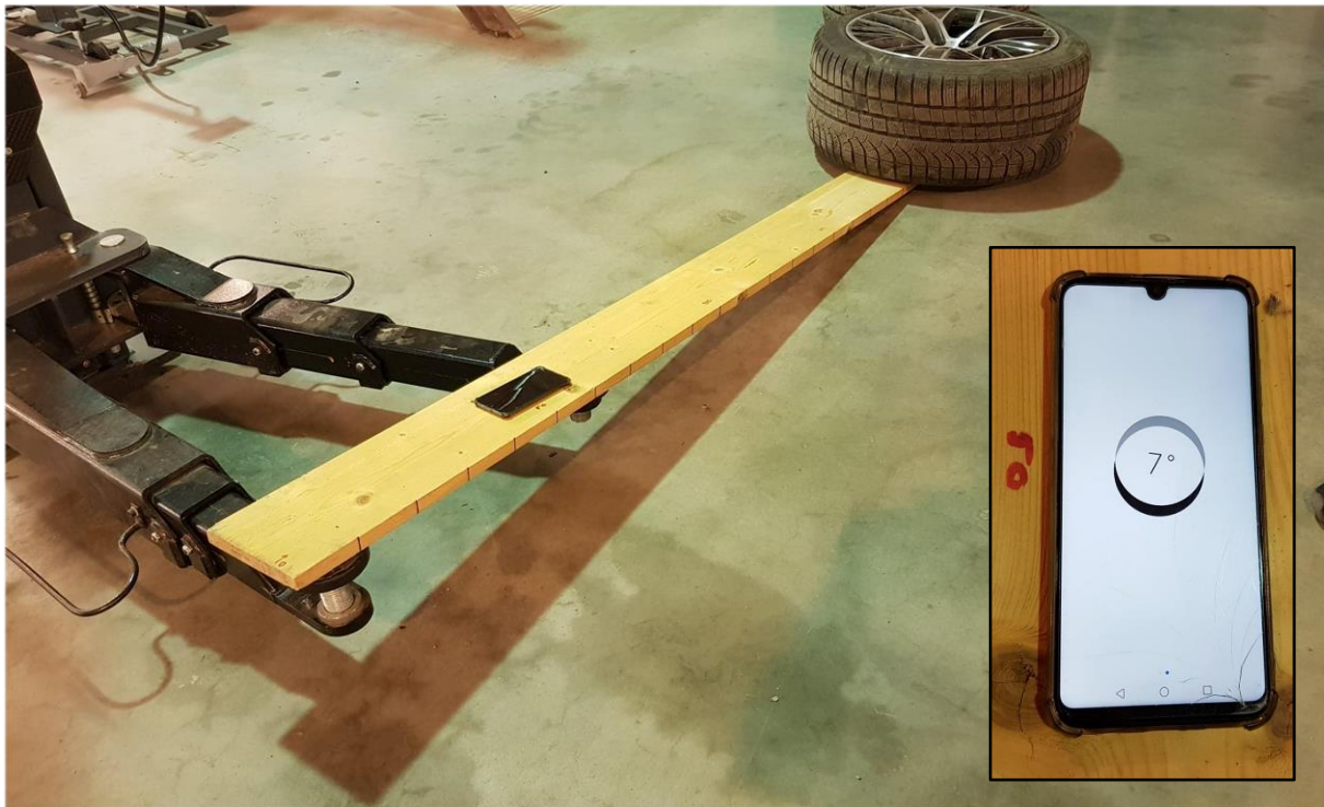
Figur 76 – Skråplanoppsett for rulling av dekk. Vinkelmål fra telefon er innfelt.
