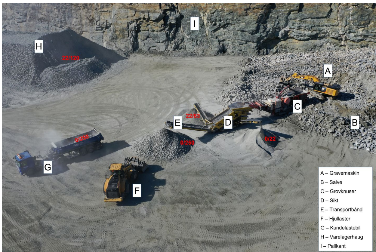
Figur 17. Eksempel på oppsett for mobilproduksjon i et av Feiring Bruks mindre anlegg. Illustrasjon: Feiring.
