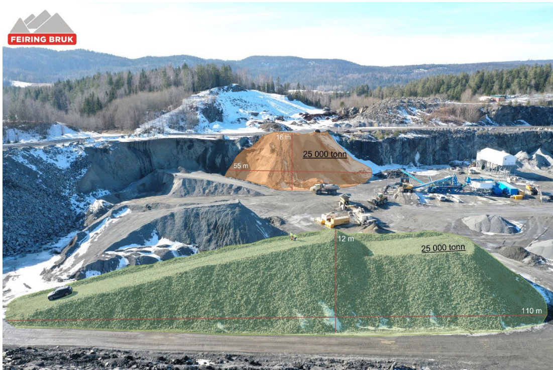
Figur 21. Illustrasjon av geometrien på to varelagerhauger med lik mengde tonn. Dette er hauger som lagres inntil ferdigdrevet paller krever mindre areal enn frittliggende hauger, og kvaliteten på varen blir ikke påvirket av at dumpere må kjøre i dem for å tippe. Illustrasjon: Feiring.
