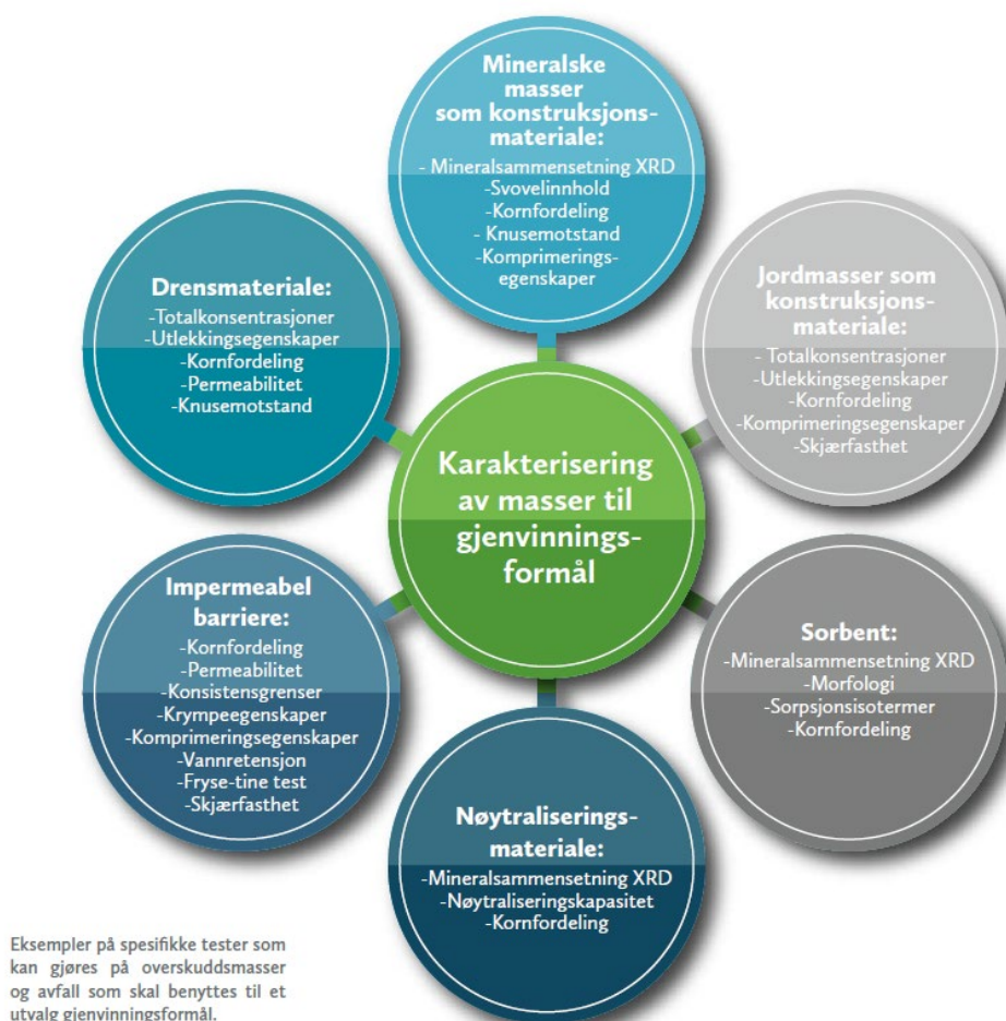
Figur 23. Eksempler på tester som kan gjøres på overskuddsmasser og avfall som skal benyttes til gjenvinningsformål. Illustrasjon: NGI/GEORECIRC [34].
