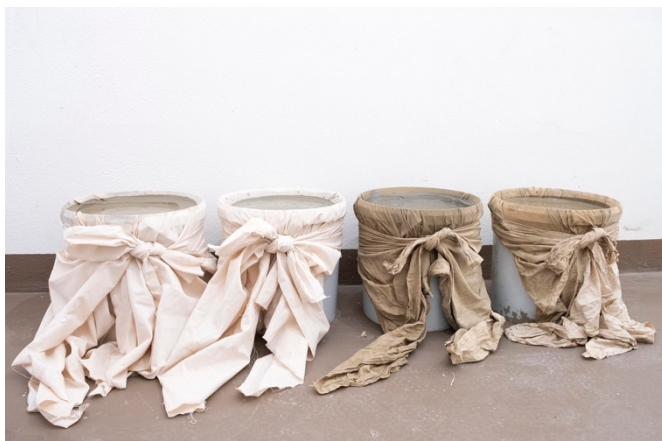
Figur 8. Vann filtreres ut av leira gjennom lerretsduker i bøtter. Foto: Silje Kjørholt
