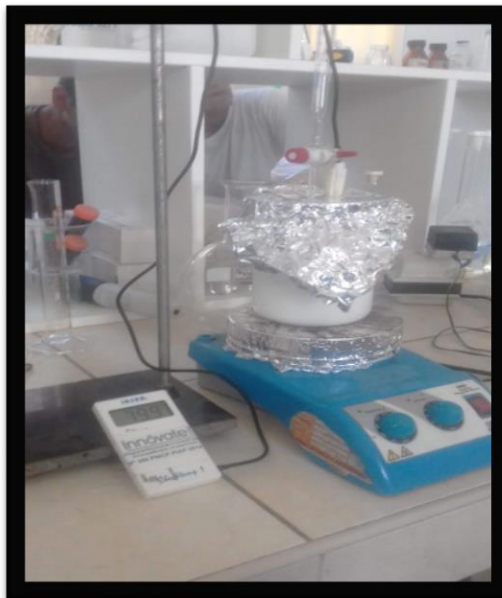
Foto N° 01: Preparación del ZnO en el laboratorio
