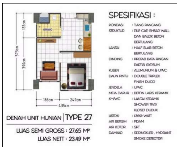
Gambar Denah Unit Hunian dan Spesifikasi Perumnas Rusunami Bandar Kemayoran A4 Sumber : Rusunami Bandar Kemayoran Booklet
