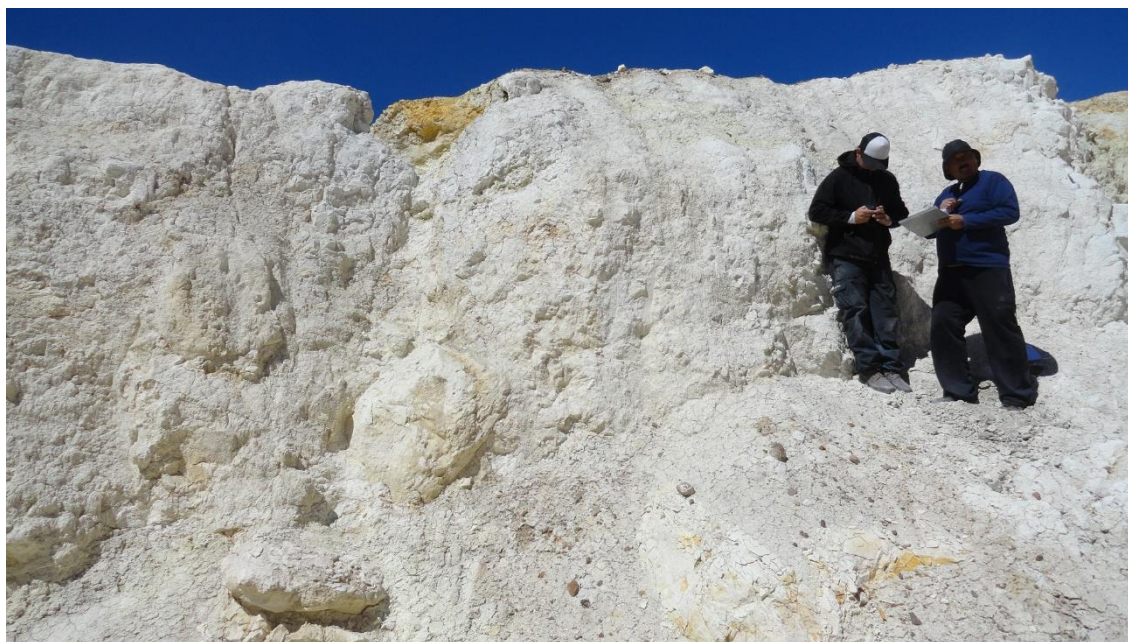
Foto 17: Minas Pama-Belgrano. Recolección de muestra CAO-017GCJ, representativa de matriz de la brecha caolinizada; obsérvense bloques de hasta 80 cm.
