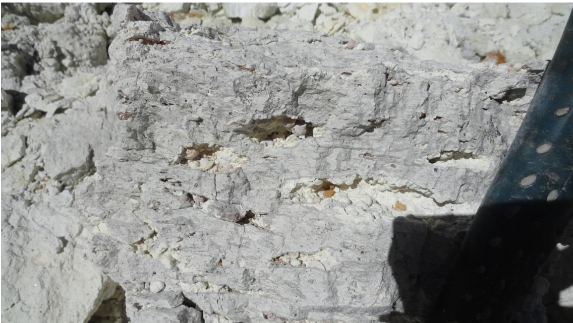
Foto 2: Mina Belgrano, detalle de fragmento de ignimbrita riolítica con fiammes parcialmente alterados a caolín.
