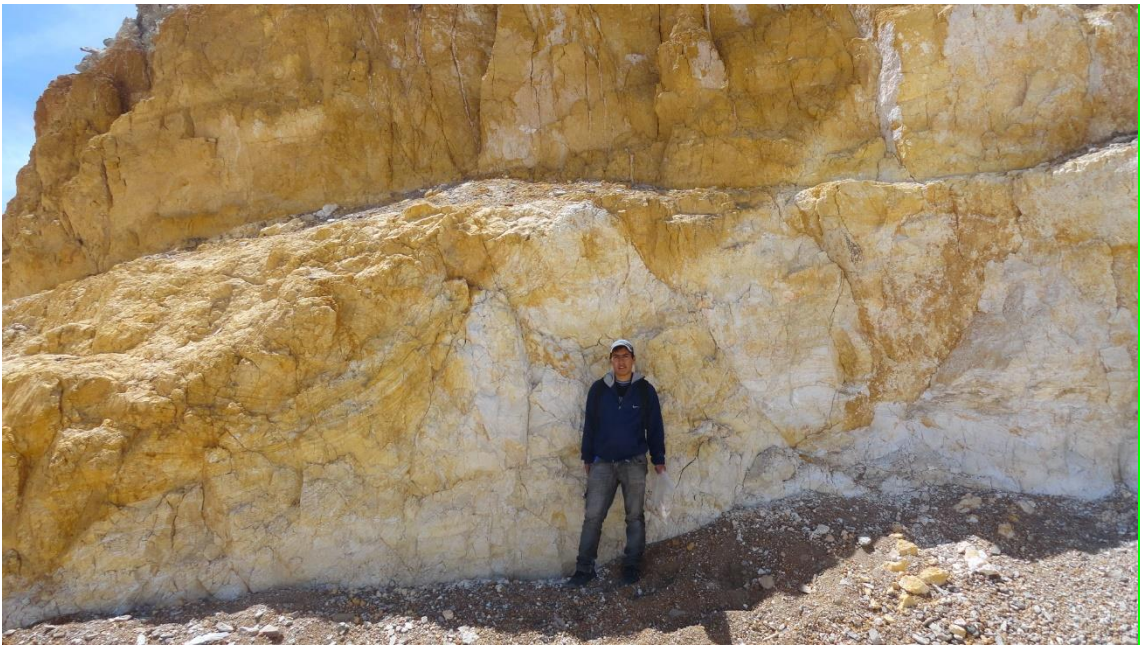
Foto 16: Minas Pama-Belgrano. Recolección de muestra CAO-011GJ, representativa de la roca total, ignimbrita caolinizada y levemente teñida por óxidos de hierro hidratados.
