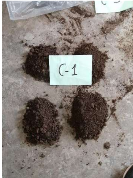
Figura 22. Cuarteo de muestras de la Calicata C – 01.
