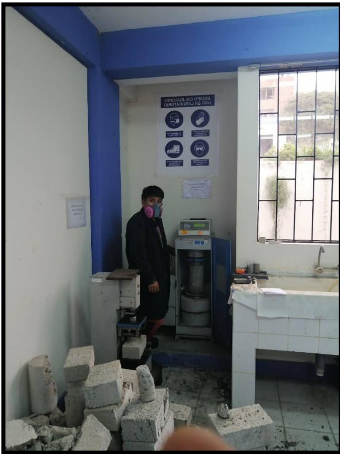
Figura 19. Realizando el ensayo a la compresión de las probetas de concreto endurecido.
