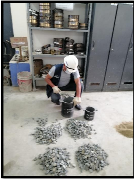
Figura 14. Realizando el peso unitario de los agregados.
