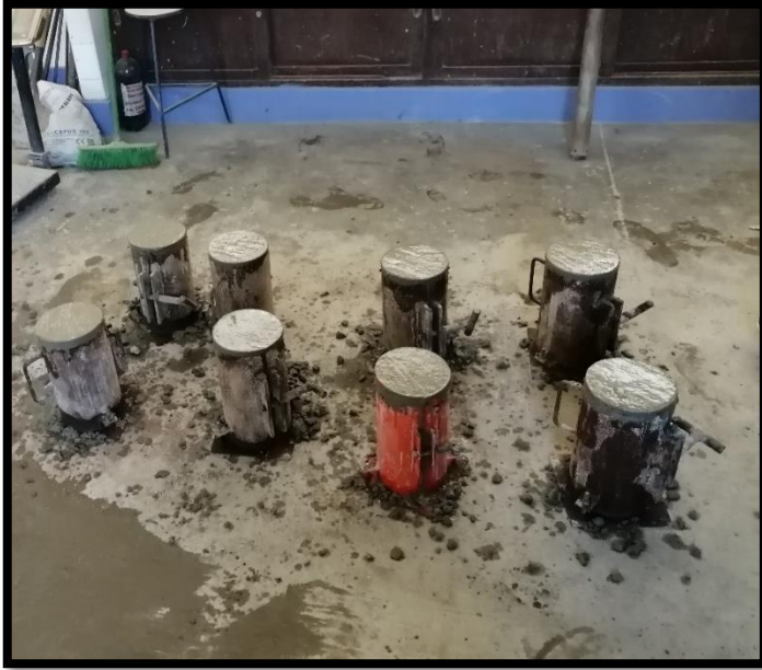
Figura 18. Dejandolas probetas de concreto para su tiempo de fragua.
