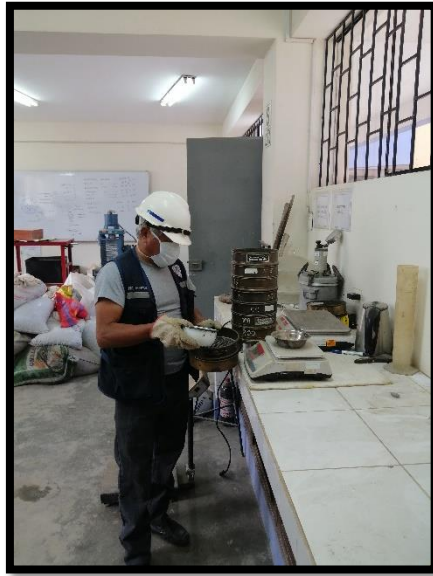
Figura 12. Realizando el análisis granulométrico de los agregados.
