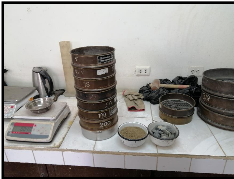
Figura 15. Realizando el análisis granulométrico de agregado fino y grueso.
