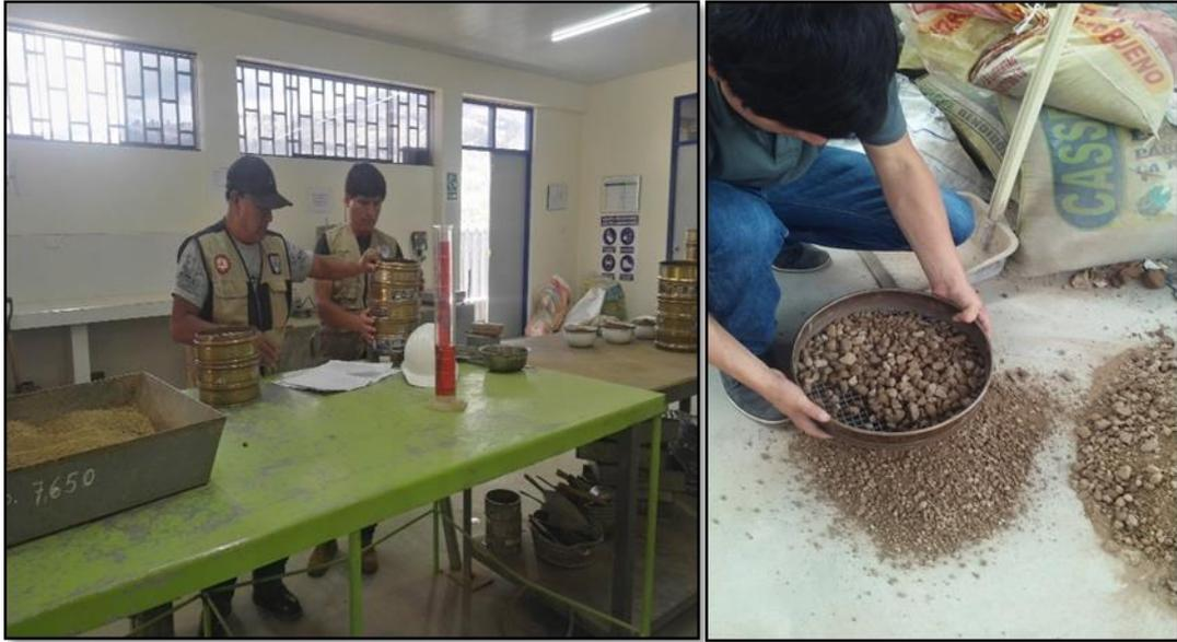
**Figura 36:** Tamizado del material
