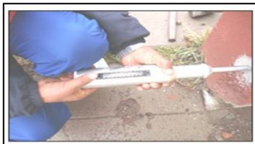
**Figura 26:** Ensayo de Esclerómetro
