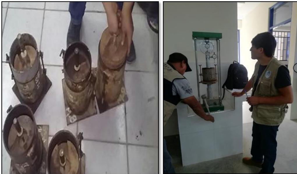
**Figura 39:** Ensayo de penetración para los resultados de Proctor y CBR
