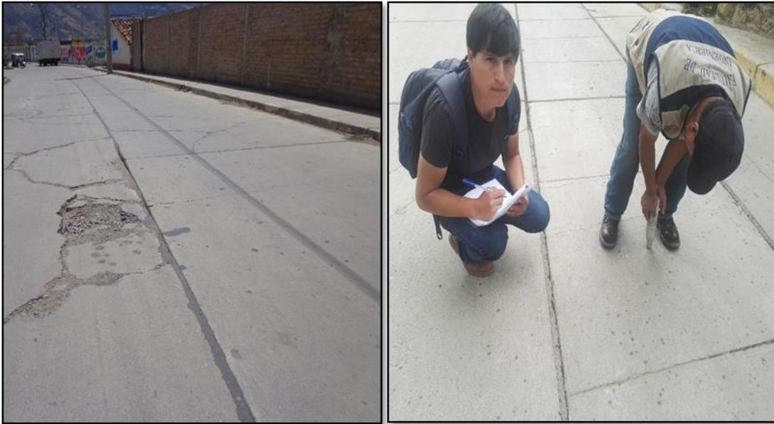
Figura 34: Ensayo de esclerómetro
