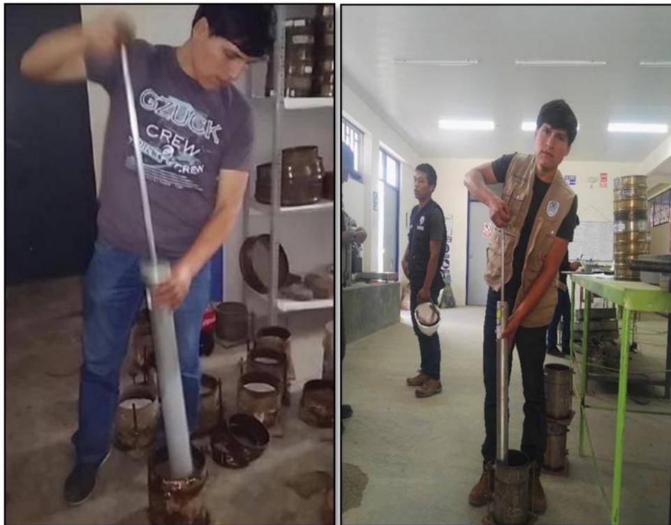
**Figura 37:** Ensayo del Proctor Modificado y CBR
