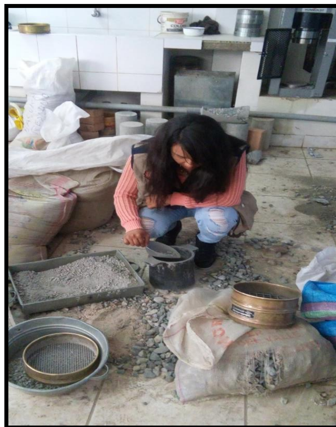
Foto N° 10: Realizando el peso unitario de la grava.
