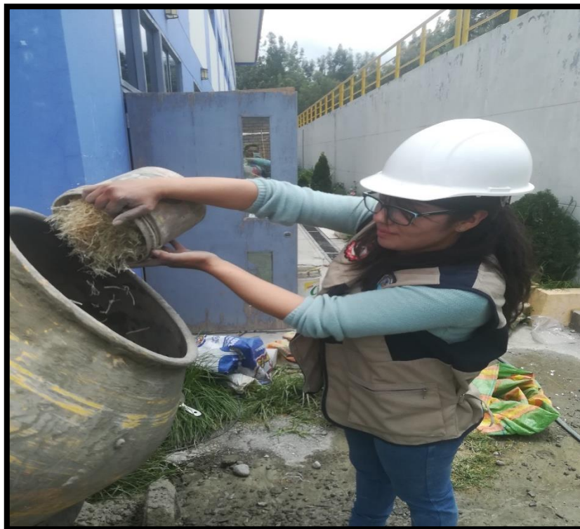
Foto N° 15: Adición de fibra de Nopal a la mezcla de concreto.
