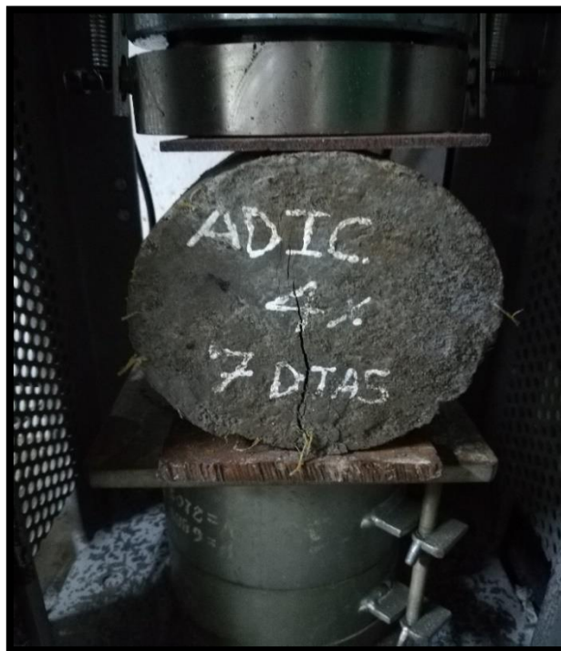
Foto N° 199: Se realizó el ensayo de tracción por compresión diametral simple espécimen experimental con 4% de fibra de nopal - Laboratorio de la USP – Huaraz
