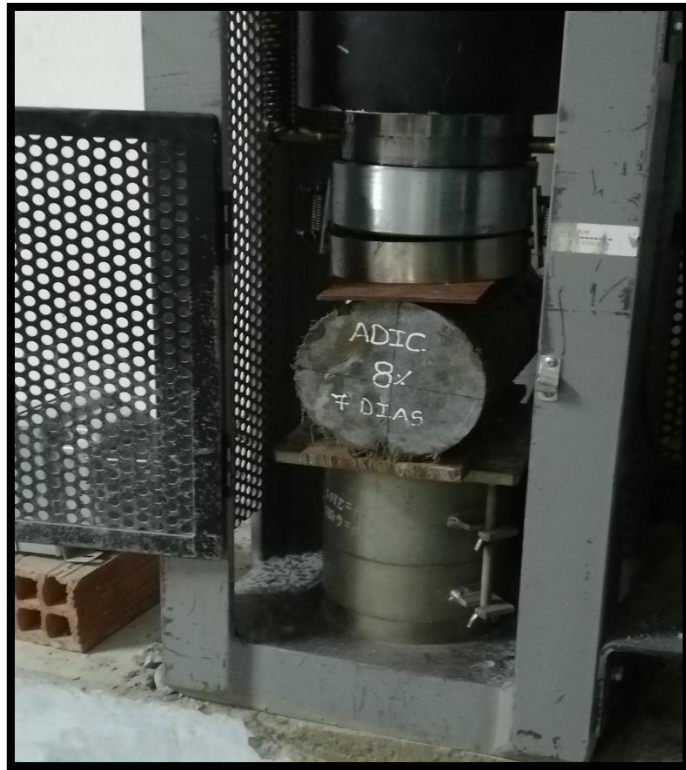
Foto N° 100: Realización de ensayo de tracción por compresión diametral simple espécimen experimental con 8% de fibra de nopal - Laboratorio de la USP – Huaraz
