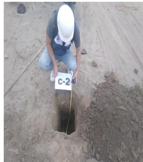
**FIGURA N°12:** Calicata C-2 para extracción de muestra.
