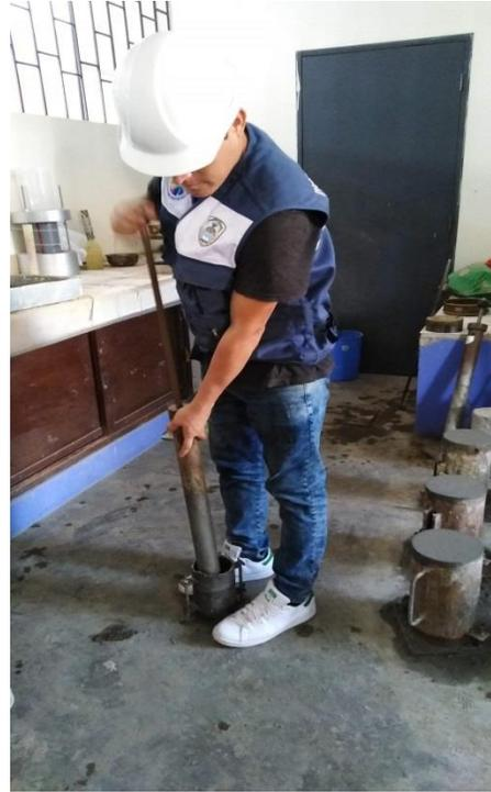
**FIGURA N°17:** Proceso de proctor modificado.
