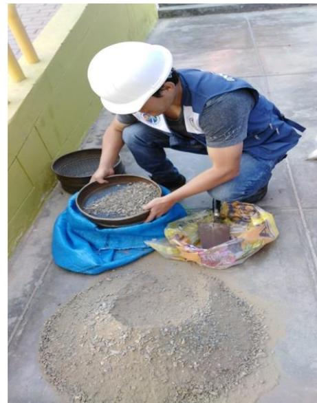
**FIGURA N°14:** Proceso de tamizado pasante por las mallas 3/4 ,3/8, N.4.
