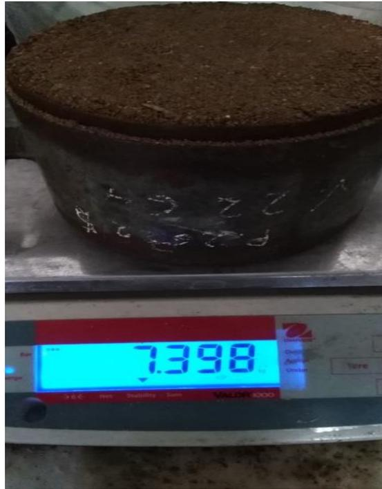
**FIGURA N°18:** Peso de muestra húmeda.
