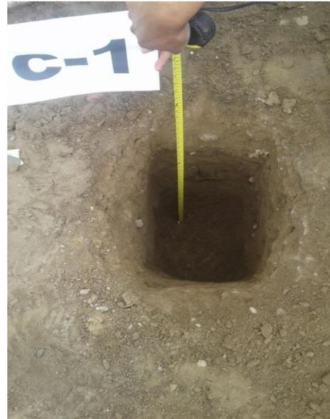
**FIGURA N°11:** Calicata C-1 para extracción de muestra.
