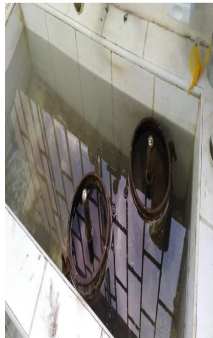
**FIGURA N°21:** Muestra de CBR en agua.
