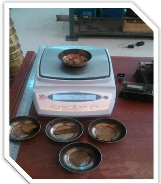
**Figura N°32.** Determinación de límites de consistencia del suelo.
